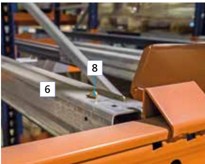
Slitte (6) e dispositivo di bloccaggio (8).
