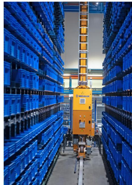
la merce automaticamente grazie agli ordini lanciati da Easy WMS e alla loro esecuzione da parte di trasloelevatori e trasportatori. Così facendo, gli operatori devono solo estrarre i prodotti dalle scatole e metterli sui pallet che, una volta completato l'ordine, saranno trasferiti alle linee di produzione. "Con questo sistema di preparazione ordini, i nostri operatori sono più produttivi. Inoltre, possono preparare gli ordini ergonomicamente", sottolinea Spinosi.
