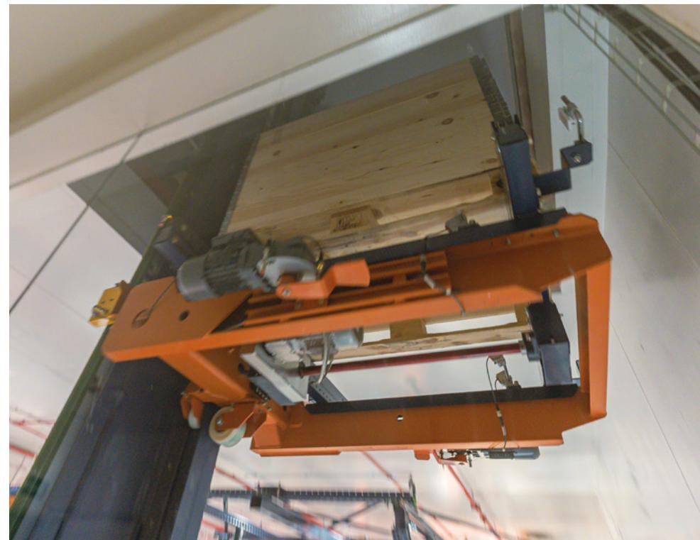
**L'elevatore mette in comunicazione bidirezionalmente il magazzino automatico con le linee di produzione**
