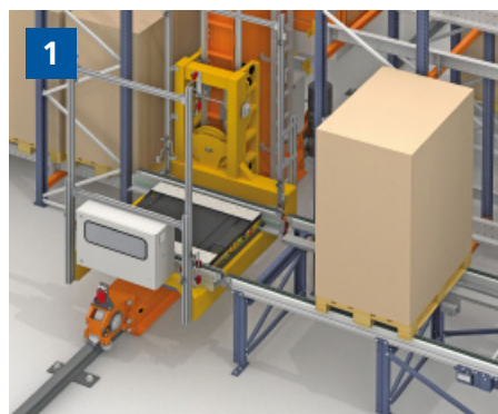
1. Il Pallet Shuttle nella culla del trasloelevatore attende l'arrivo del pallet proveniente dalla postazione di controllo.
