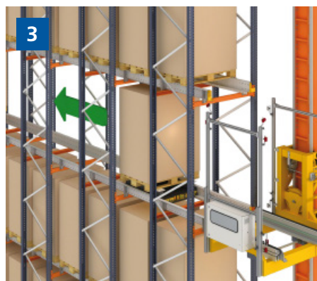
3. La navetta automatica solleva leggermente il carico e si inserisce nel canale di stoccaggio. Si sposta insieme al pallet fino alla prima ubicazione libera e una volta arrivati, lo abbassa e appoggia sulla parte superiore del binario.
