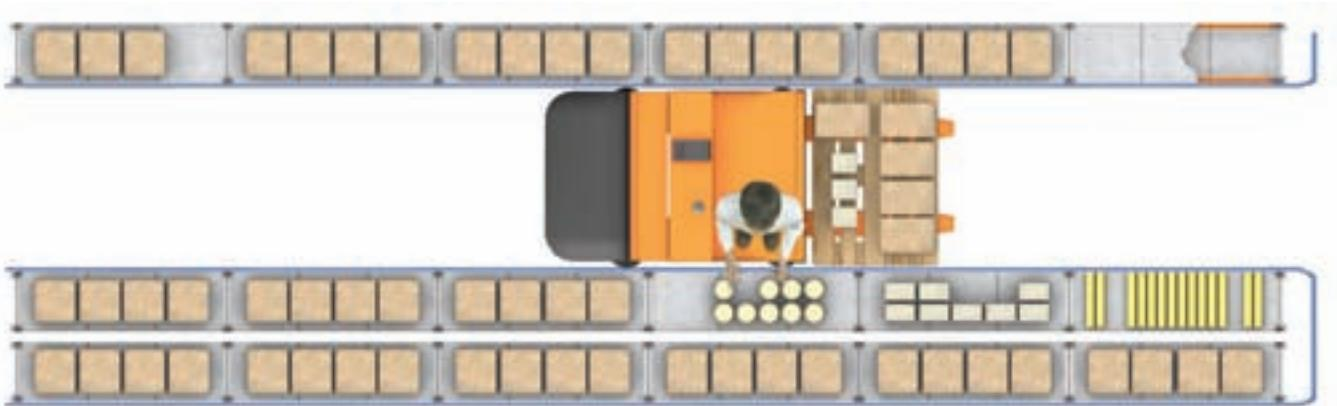
Ogni modello di macchina richiede un tipo di binario ed una larghezza di corsia differente. La larghezza della corsia è definita dalla distanza tra le guide e la distanza fra i livelli di carico.
