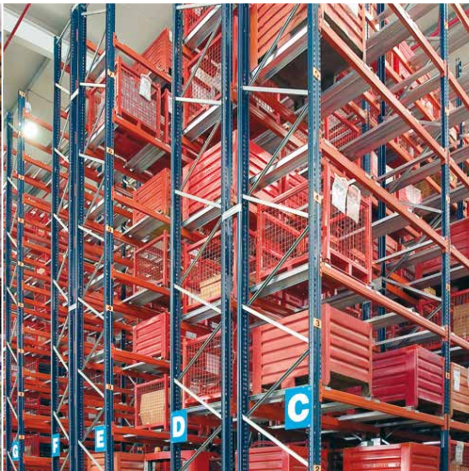
Magazzino con scaffalature portapallet per contenitori metallici
