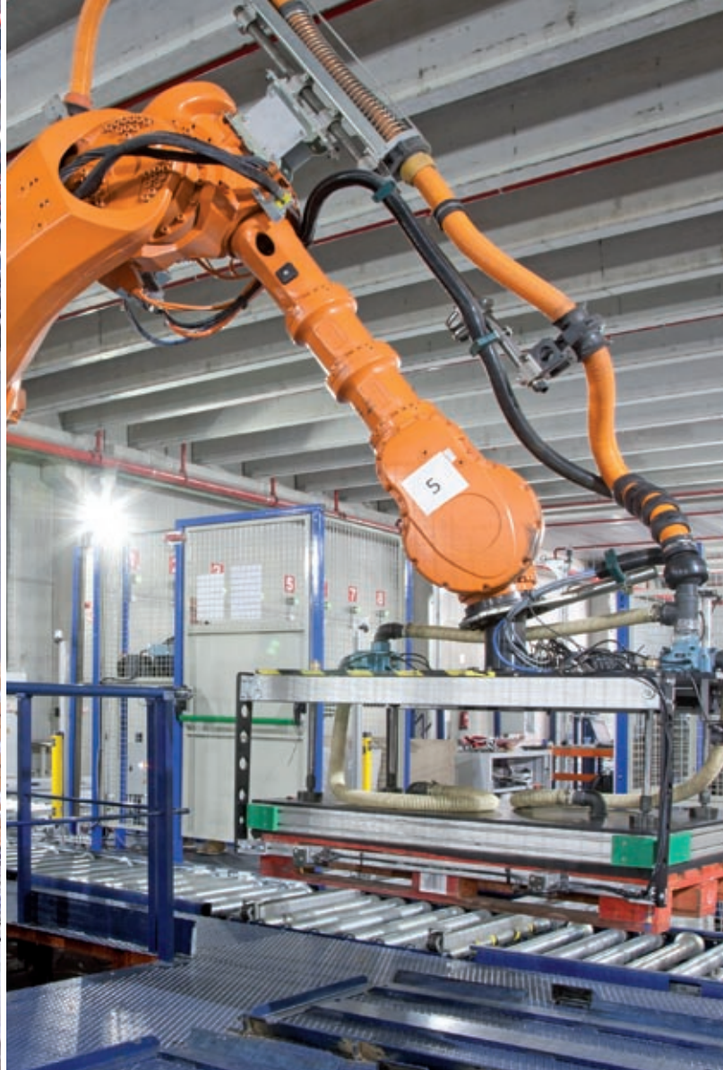
Schema di funzionamento del sistema con picking automatico e robot depalletizzatore.
