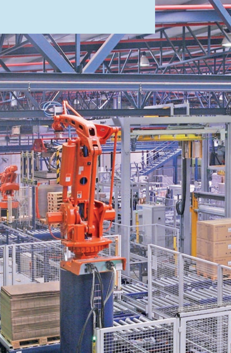
Schema di funzionamento del sistema con picking automatico e robot depalletizzatore.
