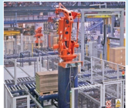
Picking automatico tramite robot depalletizzatore pagina 34
