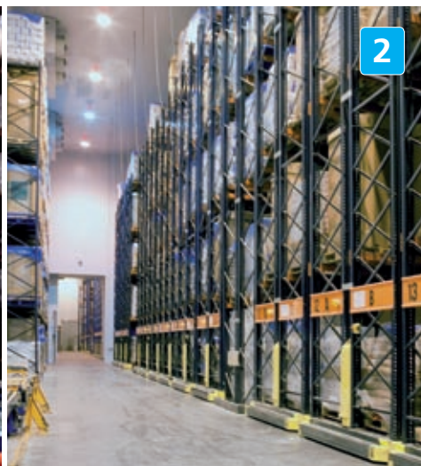
Le scaffalature compattabili vengono utilizzate per immagazzinare gli ordini a media rotazione o riposti su pallet di misure variabili.
