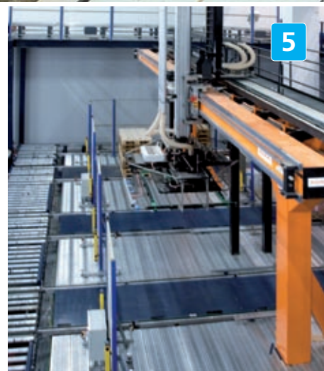
Il robot di picking automatico permette la preparazione per strati di ordini dei prodotti ad alta rotazione. L'alimentazione dei pallet avviene tramite i trasloelevatori e i trasportatori.
