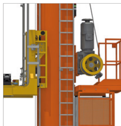
Scala verticale e piattaforma di manutenzione superiore.
