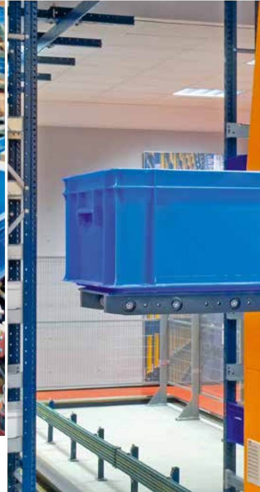
Sistema di estrazione a pale per l'estrazione di due contenitori alla volta.
