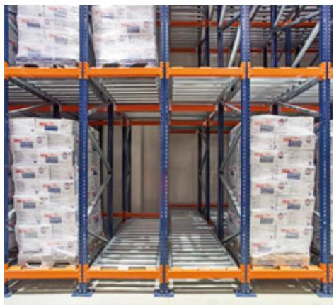
VELOCITÀ E SICUREZZA DELLE OPERAZIONI DATO CHE I CARRELLI ELEVATORI NON ENTRANO NELLE SCAFFALATURE MA LAVORANO IN UN SOLO CORRIDOIO.
