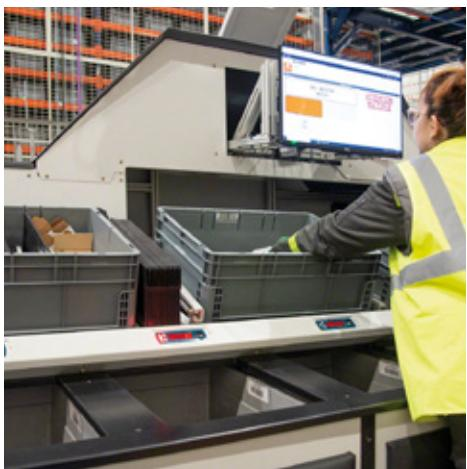
I DISPOSITIVI LUMINOSI *PICK-TO-LIGHT* VELOCIZZANO LA PREPARAZIONE DEGLI ORDINI ED EVITANO ERRORI DERIVATI DALLA GESTIONE MANUALE.
