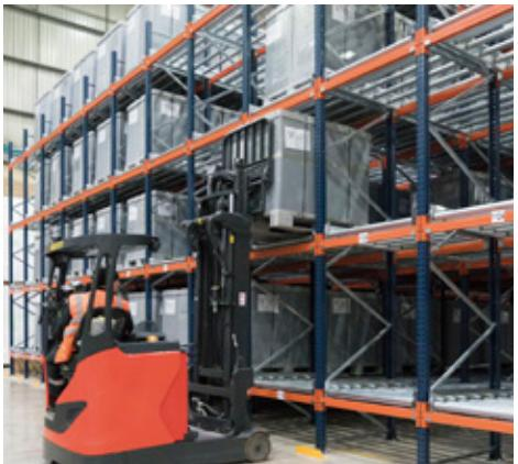
FLUSSI DI LAVORO CONTINUI: NON CI SONO INTERFERENZE TRA CARICO E SCARICO DI MERCE DESTINANDO UN CANALE PER OGNI OPERAZIONE.
