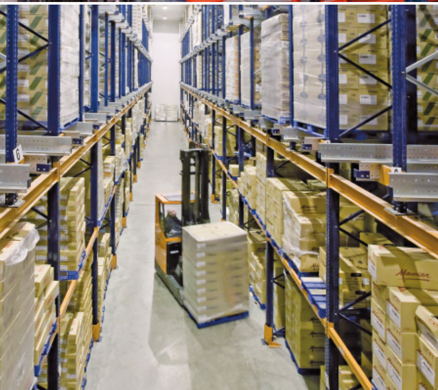
Esempio di un'installazione con blocchi di scaffalature su entrambi i lati del corridoio di lavoro (7.2).
