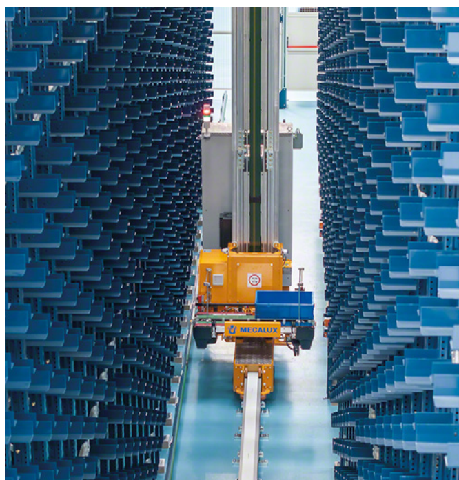
Trasloelevatore bicolonna MLB100Q In grado di raggiungere i 20 m di altezza e di trasportare due unità di carico (di 100 kg ciascuna) o quattro da 50 kg.
