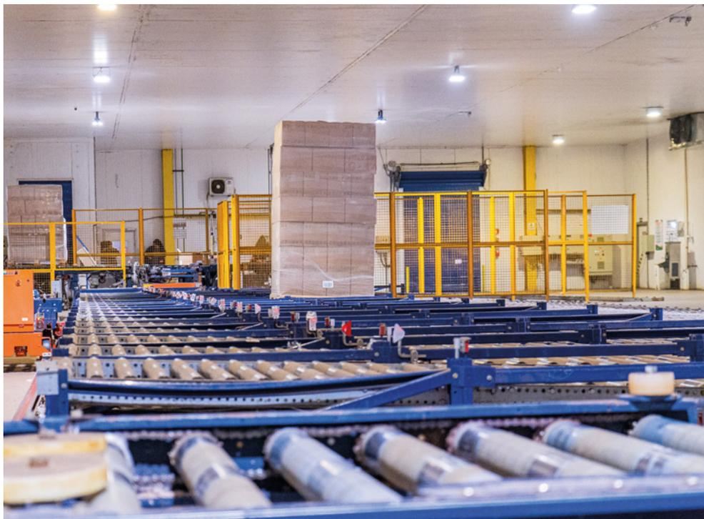
Al suo interno, il sistema Pallet Shuttle automatico deposita ed estrae la merce in modo autonomo, il che velocizza i processi di stoccaggio e spedizione dei pallet. La connessione tra i magazzini automatici e le aree di produzione e spedizione si realizza in modo automatizzato tramite trasportatori.
