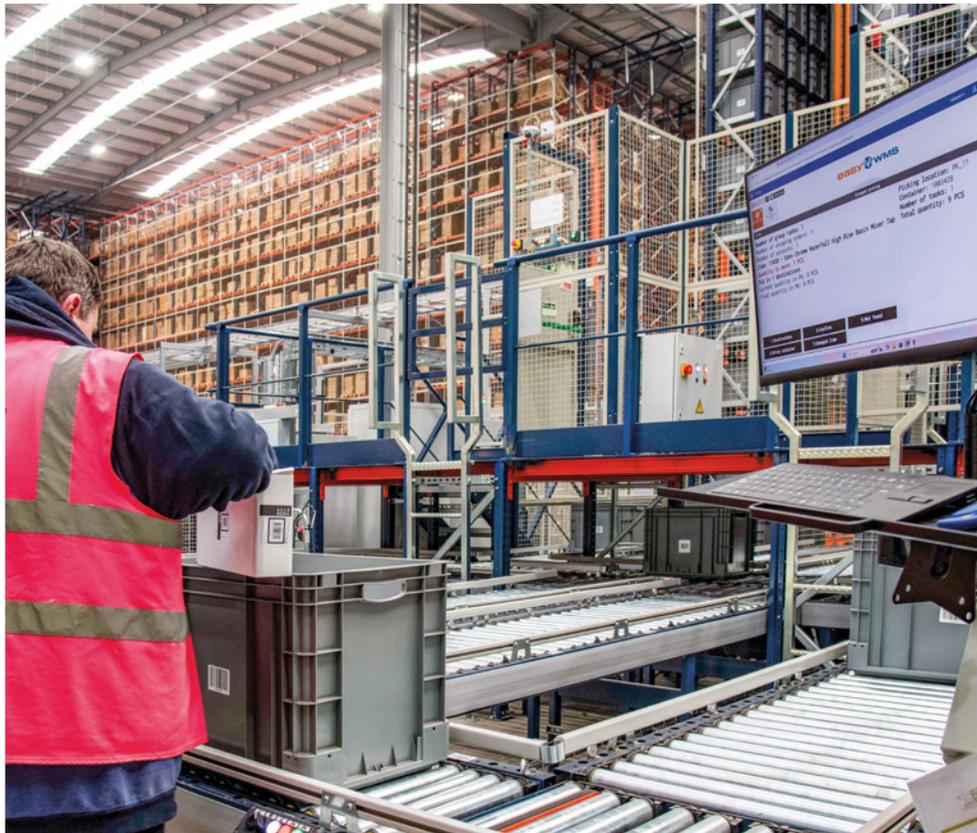
I trasportatori trasferiscono automaticamente i pallet o i contenitori fino alle postazioni di picking con tutti i tipi di articoli e accessori per il bagno, velocizzando la preparazione degli ordini
