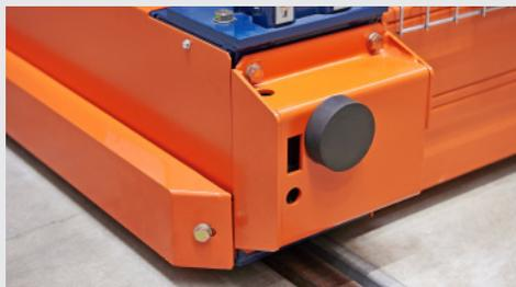
**Barriere interne.** Rilevano la presenza di oggetti nel corridoio che possono impedire al sistema di funzionare correttamente.
