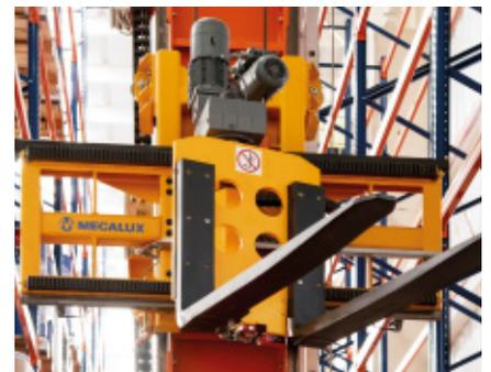
**Elemento estrattore.** La forca trilaterale viene movimentata, da una testata, a sinistra, destra o frontalmente per raggiungere il carico.
