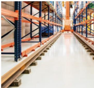
**Guide.** Si muove su due binari guida fissati alla platea ed è provvisto di un treno di scorrimento di otto ruote che ne agevolano il movimento.
