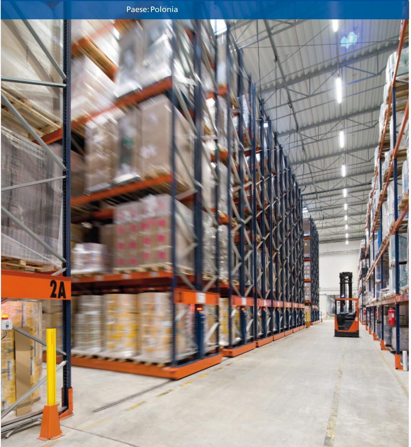
Mecalux ha installato scaffalature su basi mobili Movirack nel magazzino che l'azienda produttrice di bevande Refresco possiede a Mogielnica in Polonia. Si tratta di un sistema ad accumulo che elimina le corsie, ideale per ottenere più capacità di stoccaggio e al contempo rifornire la produzione con rapidità.
