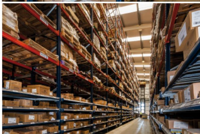
La versatilità delle scaffalature portapallet di Mecalux è ideale per aumentare la capacità di stoccaggio e velocizzare al contempo la preparazione degli ordini. La società britannica Churchill China ha tratto vantaggio da questa soluzione per il suo magazzino, aumentando di circa il 10% la produttività e del 40% lo spazio destinato al picking.
