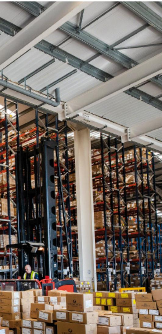
Parte dei livelli inferiori sono costituiti da canali a gravità. Qui vengono depositati due pallet, uno dietro l'altro, e gli operatori prelevano direttamente dal primo pallet gli articoli contenuti nei singoli ordini. Qui si svolge il picking dei prodotti ad alta rotazione e grazie a questo sistema che prevede di tenere i prodotti di scorta immediatamente dietro, la merce è sempre disponibile e si evitano interruzioni del servizio.
