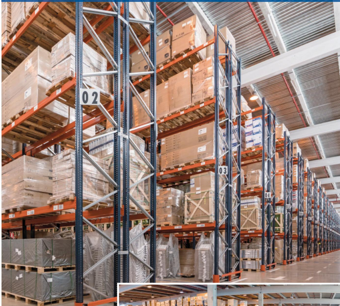
I due nuovi magazzini che Leroy Merlin ha costruito a Torija (Spagna) sono costituiti da scaffalature portapallet di Mecalux. Complessivamente, offrono una capacità di oltre 21.600 posti pallet. È un sistema che si distingue per la sua versatilità e velocità nello stoccaggio di pallet diversi per volume e dimensioni.
