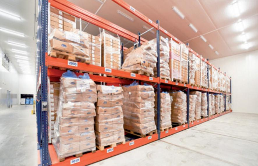
Comag ha attrezzato il magazzino per surgelati di Mondovì, in Italia, con due blocchi di scaffalature per pallet su basi mobili Movirack. Questo sistema garantisce una capacità di stoccaggio di oltre 2.000 posti pallet, mantenendo l'accesso diretto alla merce.
