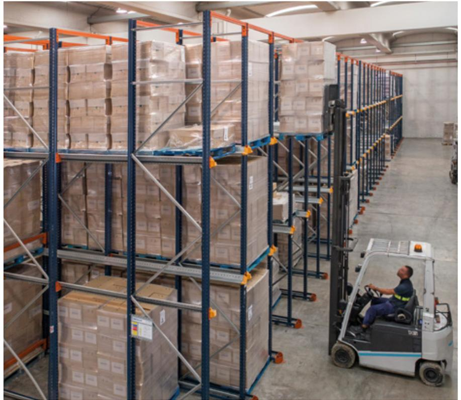
I livelli di ogni tunnel dispongono di binari GP su entrambi i lati, realizzati in una forma triangolare che occupa pochissimo spazio in altezza e agevola la sistemazione e l'appoggio dei pallet
