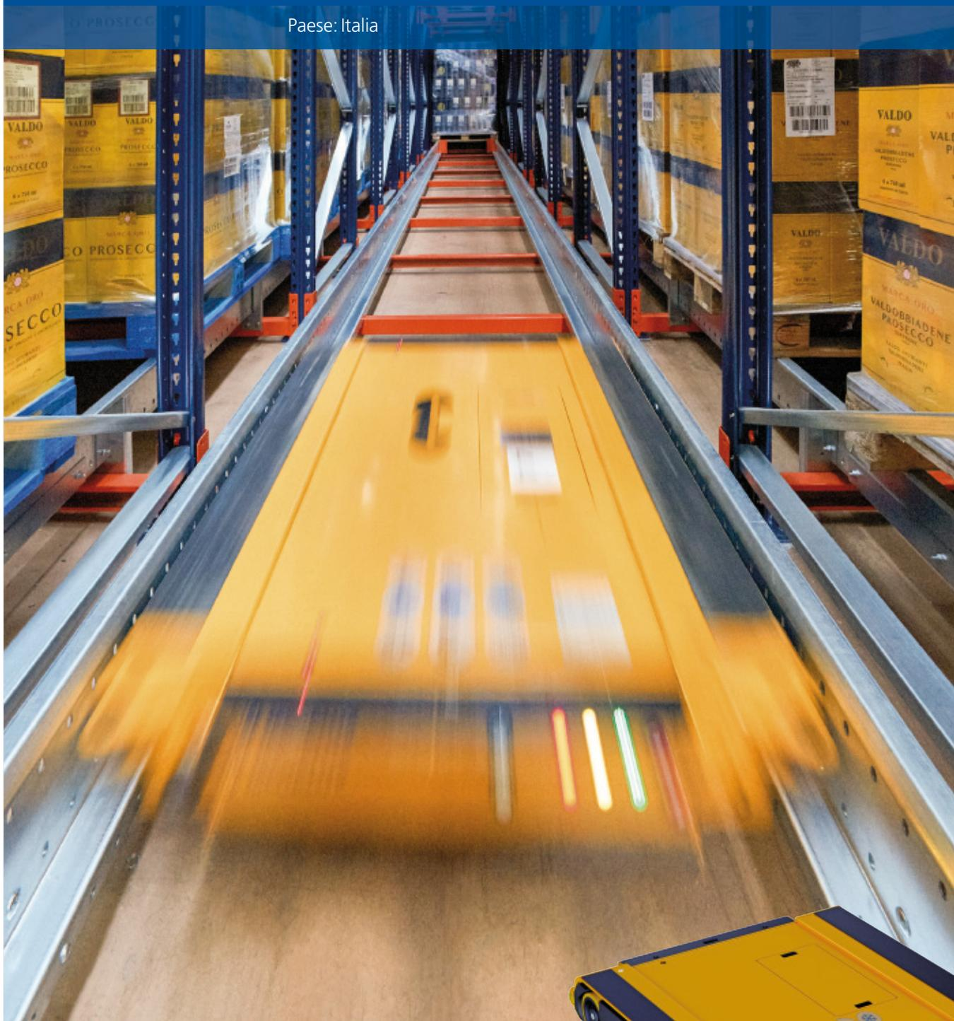
L'operatore logistico Logistic Net ha attrezzato il suo magazzino di Bassano del Grappa, con scaffalature a stoccaggio intensivo servite da quattro navette Pallet Shuttle di Mecalux che trasportano la merce all'interno del canale di stoccaggio. Con questa soluzione, l'azienda specializzata in logistica integrata conto terzi può stoccare oltre 3.000 pallet e controllarli con un tablet.
