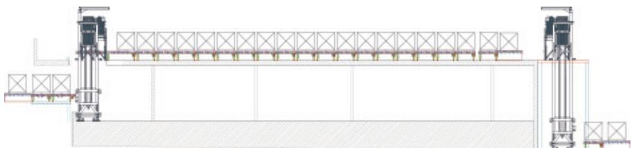
Un elevatore trasferisce i pallet fino al livello dei trasportatori, che si trovano ad altezza elevata sia all'inizio che alla fine del ponte
