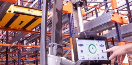
Per la gestione dei processi di stoccaggio si utilizzano dei tablet con cui si trasmettono gli ordini alle navette Pallet Shuttle. Questi tablet sono dotati di uno schermo touch screen e di un software molto intuitivo che non richiede nessuna formazione per essere utilizzato.
