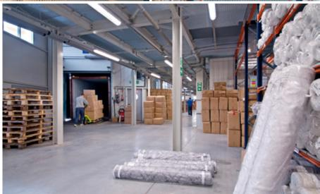
Il picking si basa sul criterio di uomo verso prodotto, vale a dire che gli operatori, con l'ausilio di un terminale a radiofrequenza, si dirigono verso le ubicazioni indicate dal software di gestione dei magazzini (SGM) e, una volta lì, prelevano gli articoli che compongono ciascun ordine direttamente dai ripiani. In seguito, gli articoli sono controllati, consolidati e classificati in un'area di precarico, in attesa di essere inviati alla spedizione.
