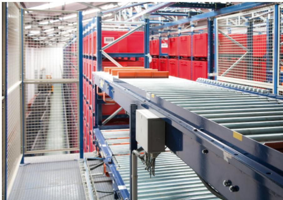
Mecalux ha fornito un magazzino automatico miniload con una capacità di oltre 14.200 casse e una testata su due livelli: la parte inferiore per il picking e la parte superiore per il riassortimento
