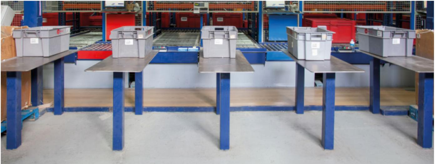
La testata del magazzino automatico di Unidroco dispone di quattro postazioni di picking dotate di dispositivi 'put-to-light'
