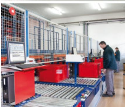
**Unidroco, grossista leader nel settore della drogheria e della profumeria specializzato nella distribuzione, dispone nel suo centro logistico di Barcellona di un magazzino automatico miniload con una capacità di 14.200 casse da 800 x 600 mm. L'impianto, predisposto per eseguire il riassortimento dei prodotti in modo automatico e senza dover interrompere la preparazione degli ordini, è controllato dal sistema di gestione magazzini Easy WMS di Mecalux.**
