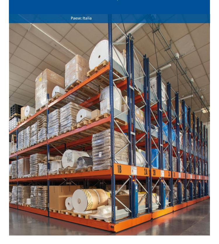
Besafilm ha attrezzato il suo magazzino di Colognola ai Colli, in provincia di Verona, con scaffalature su basi mobili Movirack di Mecalux. Questo sistema a stoccaggio intensivo sfrutta tutto lo spazio disponibile per offrire una capacità di stoccaggio di 2.032 posti pallet. In più, offre accesso diretto alla merce una volta che viene aperta la corsia di lavoro.
