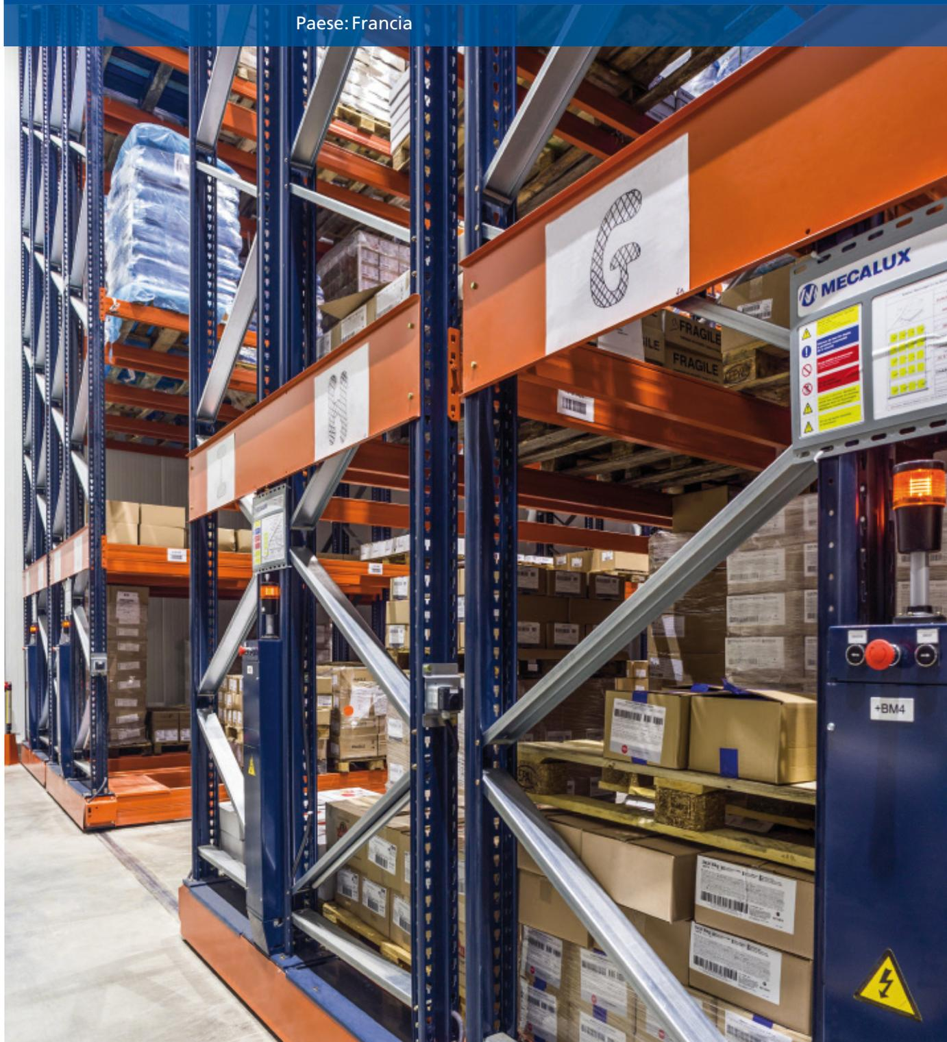
Mecalux ha montato il sistema di stoccaggio su basi mobili Movirack negli impianti di proprietà di Entrepôts Frigorifiques Charité a Vaux-Les-Près (Francia). Con questa soluzione l'azienda sfrutta al massimo la superficie per stoccare a basse temperature oltre 1.000 pallet dei suoi clienti.
