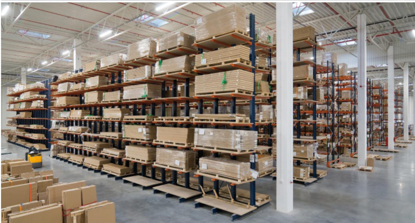
MYCS ha attrezzato con scaffalature portapallet e cantilever di Mecalux il suo nuovo centro logistico di 12.748 m<sup>2</sup> a Szczecin (Polonia). La caratteristica principale delle due soluzioni è la flessibilità, caratteristica che permette di adattarle alle dimensioni e ai volumi dei prodotti (componenti per arredi come tavoli, scaffalature e armadi). Inoltre, offrendo accesso diretto alla merce, rendono più dinamica la gestione dei carichi e facilitano il controllo dello stock.
