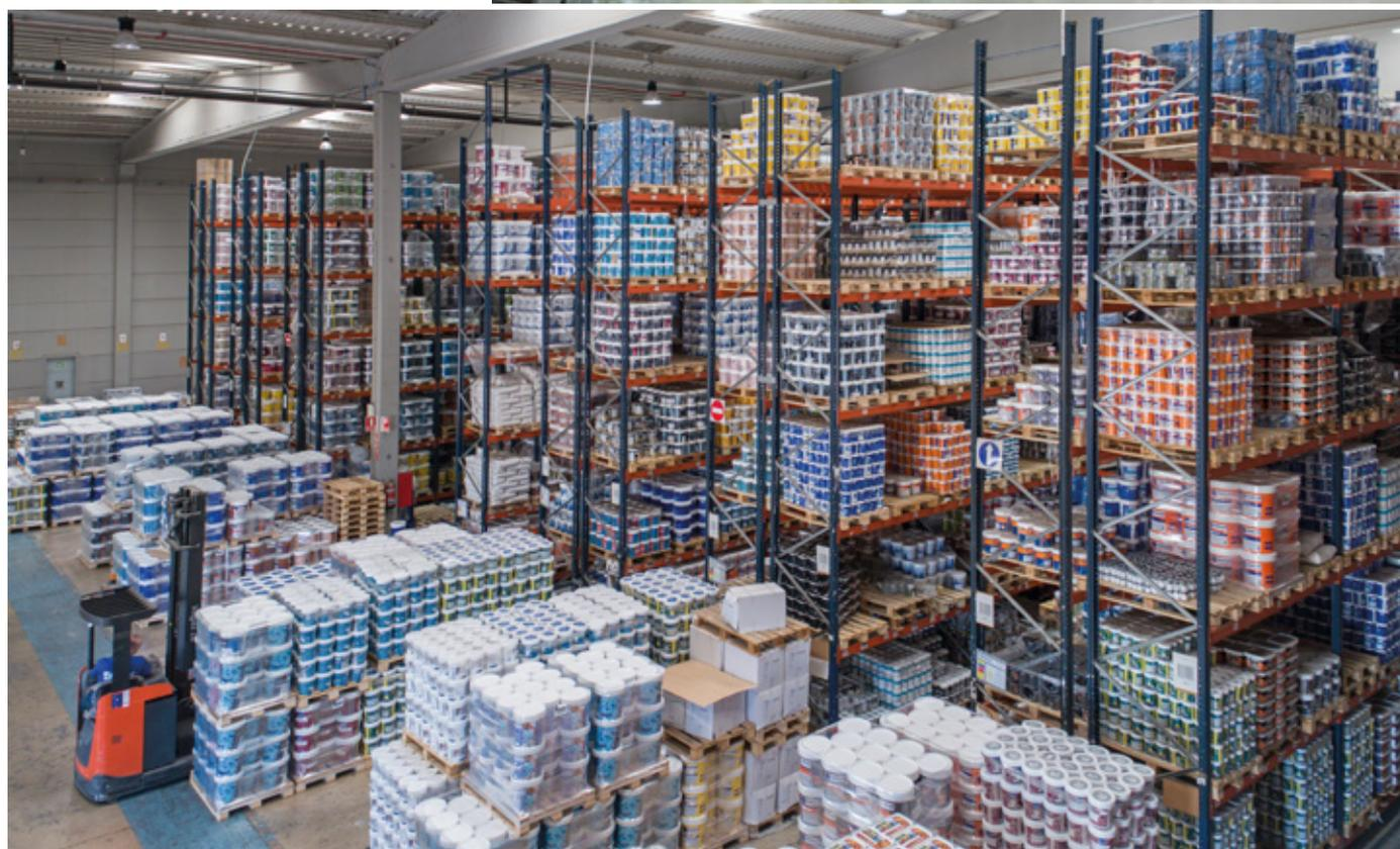
Tenendo conto di queste premesse, Mecalux ha installato scaffalature portapallet, che complessivamente offrono una capacità di stoccaggio di 4.000 posti pallet. Qui si depositano i prodotti finiti, provenienti dal centro di produzione, pronti per la spedizione.
