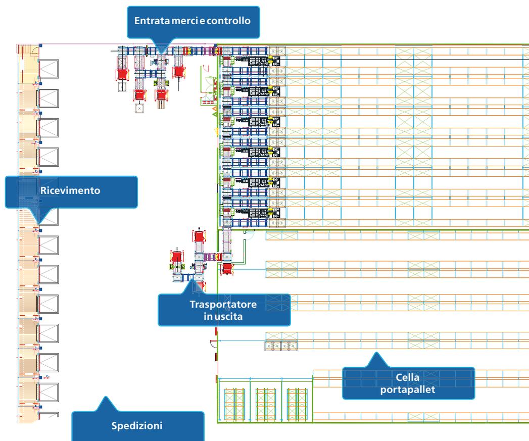
La cella di congelamento autoportante ha un ciclo operativo completamente automatico e una capacità di stoccaggio che supera i 16.000 posti pallet
