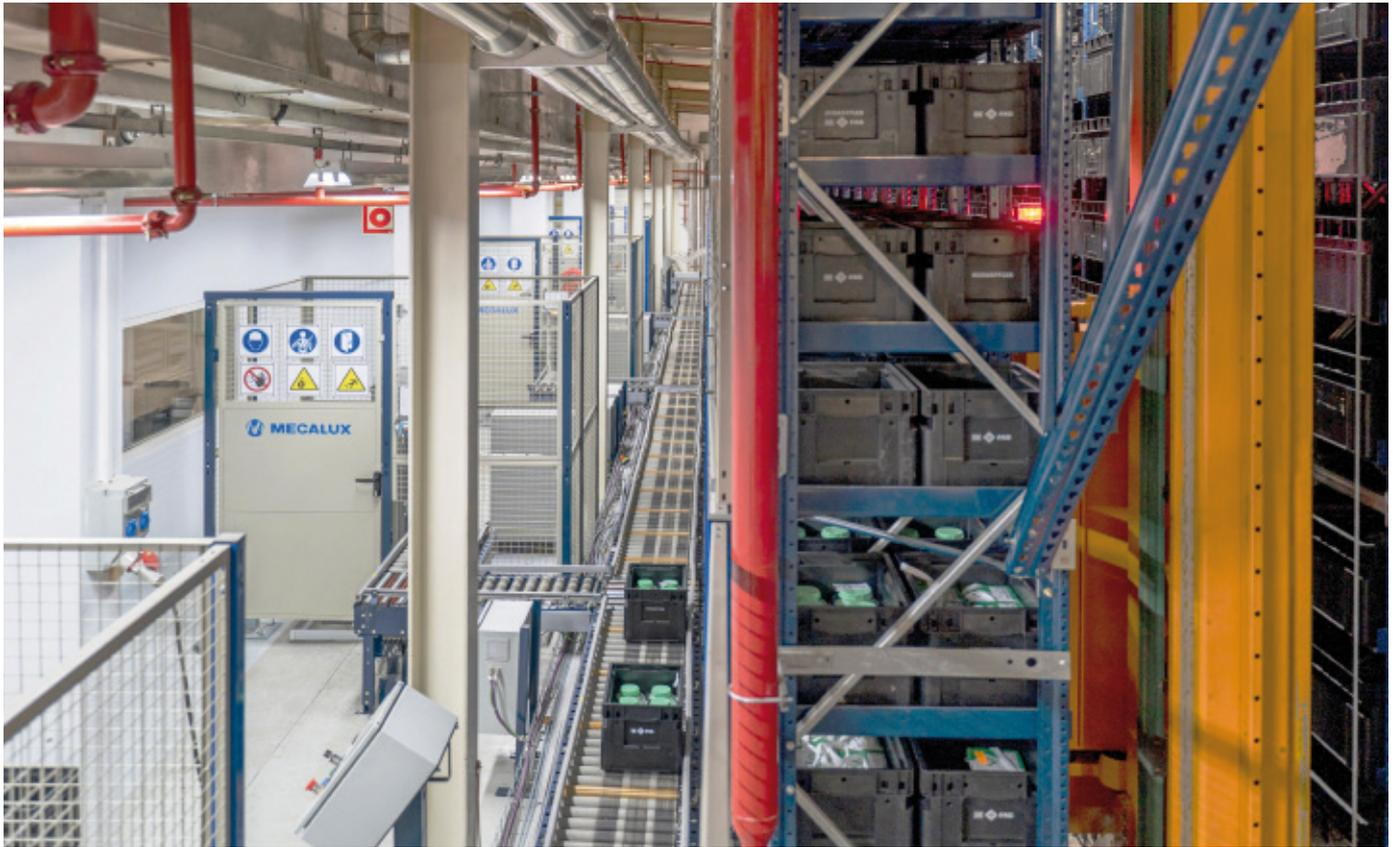
**Sono stati installati un totale di nove elevatori che connettono gli stabilimenti del centro separati da 4,47 m di altezza. Sette di essi collegano le linee di produzione con il magazzino automatico e gli altri due portano la merce al piano inferiore dove si trova la zona di preparazione degli ordini e la spedizione.**
