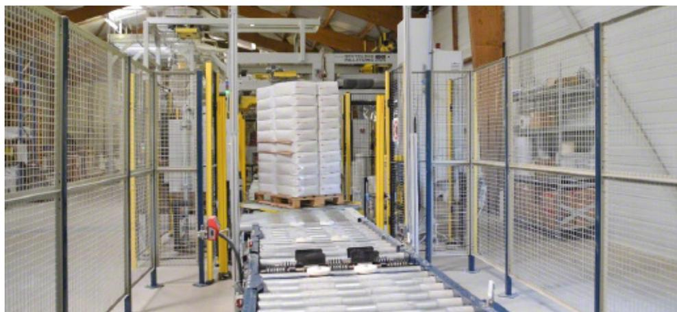
Quale soluzione di Mecalux è stata installata? Un magazzino automatico per pallet per lo stoccaggio dei prodotti finiti, nastri trasportatori automatizzati che collegano il magazzino alle linee di produzione e il software di gestione magazzini Easy WMS.
