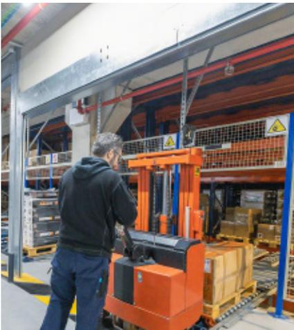
**Canali a gravità nel livello inferiore del magazzino automatico portapallet, dotato di un sistema *pick-to-light*.**
