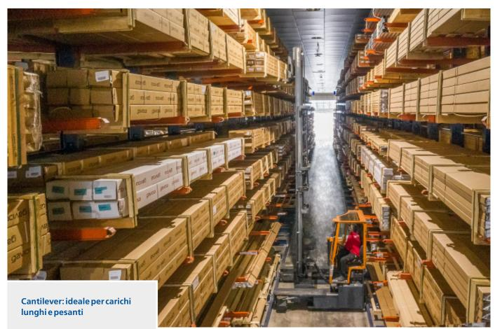
Unità di carico di grandi dimensioni. Sono specificamente progettate per stoccare merci ingombranti di lunghezza variabile, come i profili gestiti da Gaviota.
