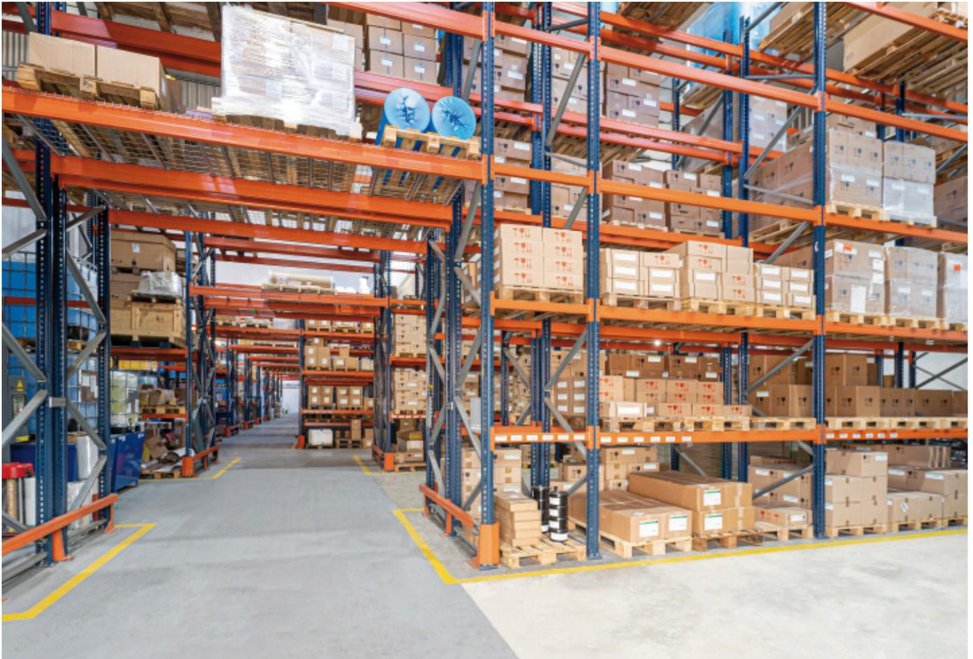
si fornitori di soluzioni di stoccaggio. Dopo un'attenta valutazione, Heidelberg ha optato per l'offerta di Mecalux: scaffalature portapallet alte 6,5 m con una capacità di stoccaggio di 1.549 posti pallet,
