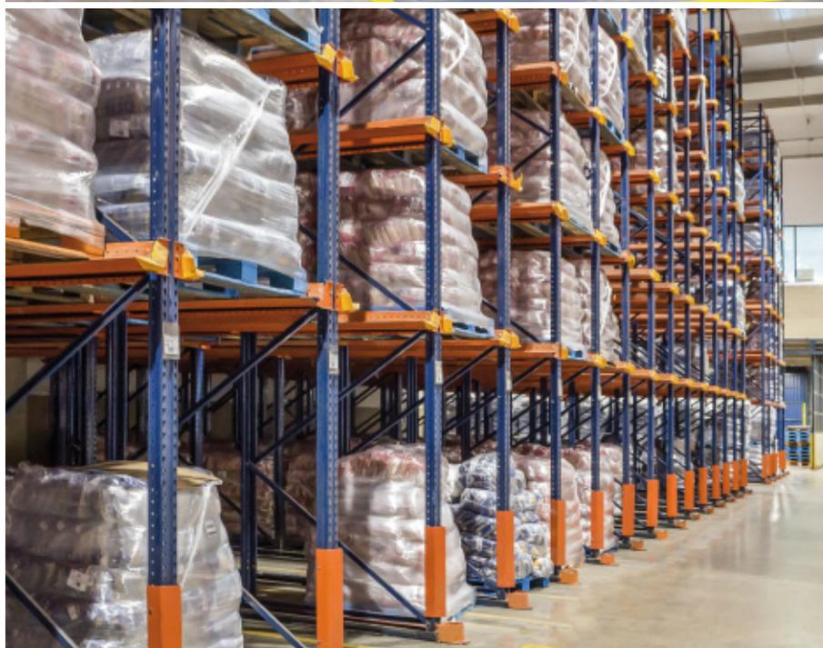
Gli operatori, aiutati da carrelli retrattili, entrano nei tunnel con i carichi elevati al di sopra del livello su cui sarà depositato. A terra sono stati posizionati dei binari guida che permettono di entrare con il carrello elevatore in modo centrato e di circolare all'interno dei tunnel in totale sicurezza, riducendo al minimo la possibilità di danni accidentali alle scaffalature.
