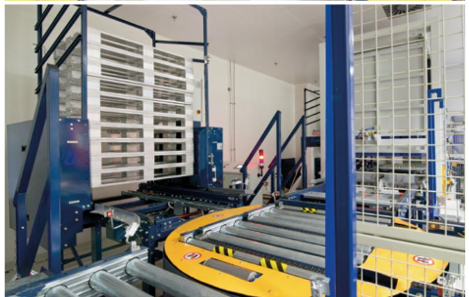
Il sollevatore/dispenser di pallet raggruppa i pallet vuoti mediante un sistema a elevazione. Per disimpilarli, li deposita uno a uno sui trasportatori. Questo sistema riduce il deterioramento dei pallet, mantiene in ordine l'area di stoccaggio e aumenta la sicurezza degli operatori.
