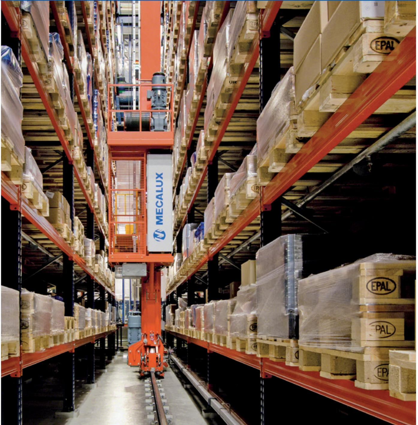
Nell'industria farmaceutica, il controllo sicuro e totale dello stock aiuta a conservare le proprietà dei medicinali ed elimina ogni possibilità di errore in tutti i processi. Con l'aiuto di Mecalux, la multinazionale Novartis ha appena inaugurato un nuovo magazzino autoportante in Polonia con una capacità di 14.304 posti pallet e un ciclo operativo completamente automatico.
