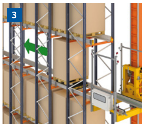
3. La navetta automatica solleva leggermente il carico e si inserisce nel canale di stoccaggio. Si sposta insieme al pallet fino alla prima ubicazione libera e una volta arrivati, lo abbassa e appoggia sulla parte superiore del binario.
