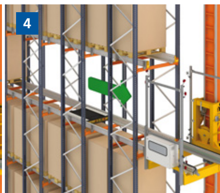
4. Il trasloelevatore attende che il Pallet Shuttle finisca e salga di nuovo automaticamente sulla culla.
