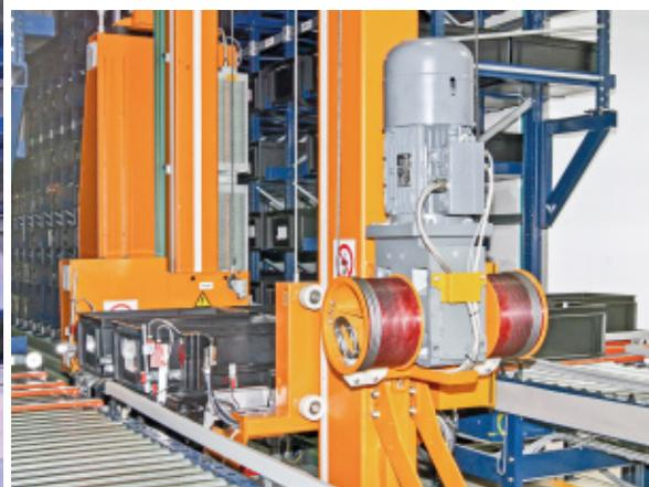
Il trasloelevatore comprende due estrattori per doppio contenitore e a doppia profondità in grado di movimentare un totale di quattro contenitori alla volta e di accedere alla seconda posizione di ogni ubicazione delle scaffalature
