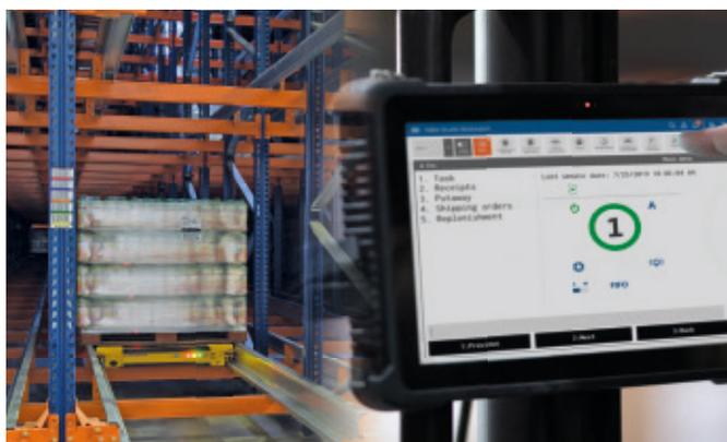
Lo Shuttle viene integrato a una scaffalatura a stoccaggio intensivo che sfrutta al massimo lo spazio del magazzino eliminando i corridoi. Inoltre, questa soluzione si adatta alla logica di ubicazione ed estrazione LIFO o FIFO, in base alle necessità.
