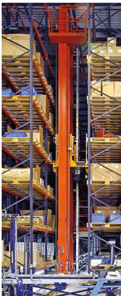
I trasloelevatori sono macchine progettate per lo stoccaggio automatico delle unità di carico mediante movimenti automatizzati. Le entrate e le uscite merci vengono eseguite ottimizzando gli spostamenti (ciclo combinato). Ciò incrementa la produttività degli impianti facendo diminuire al tempo stesso l'impiego di risorse per il loro funzionamento.
