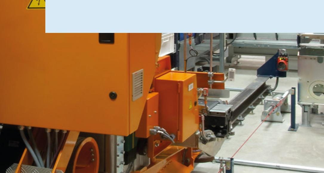
L'alimentazione di potenza, sicurezza e trasmissione, tanto per il movimento orizzontale quanto per quello verticale, viene realizzata tramite un sistema senza cavi né catene portacavi, evitando così manutenzioni costose e complesse.
