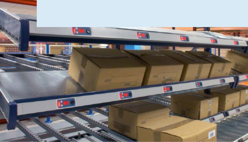
Alcune delle funzionalità descritte nelle tabelle dei livelli necessitano di soluzioni tecnologiche molto specifiche. Tra queste, la funzionalità di *pick to light/put to light*, inclusa nel blocco di Spedizioni, e l'uso della radiofrequenza nei cicli operativi del magazzino.
