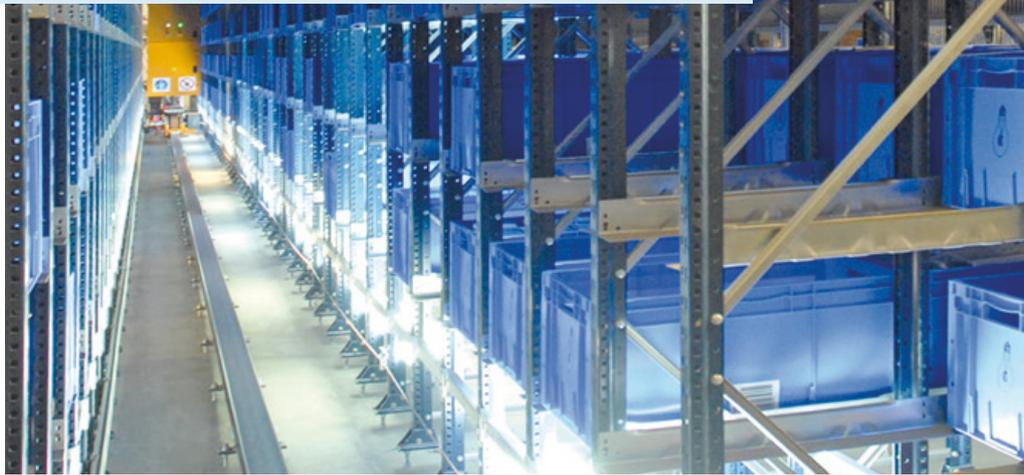
L'equipaggiamento di corsia è composto da una rotaia inferiore, una rotaia guida superiore, sistemi di misurazione di posizione e sistemi di cambio corsia.
