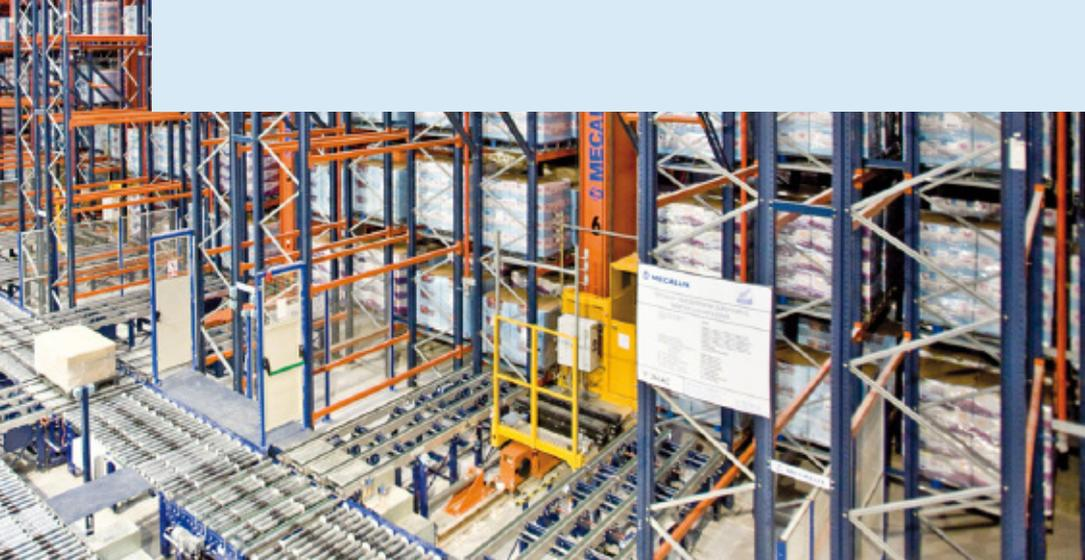
L'accurata progettazione dei trasloelevatori permette di minimizzare gli sforzi trasmessi alla struttura portante, evitando elevate sollecitazioni alle scaffalature o alla struttura del magazzino. Per questo il trasloelevatore si compone dei seguenti elementi: colonne, telaio inferiore, testata superiore, azionamento di elevazione e pianale di elevazione o culla.
