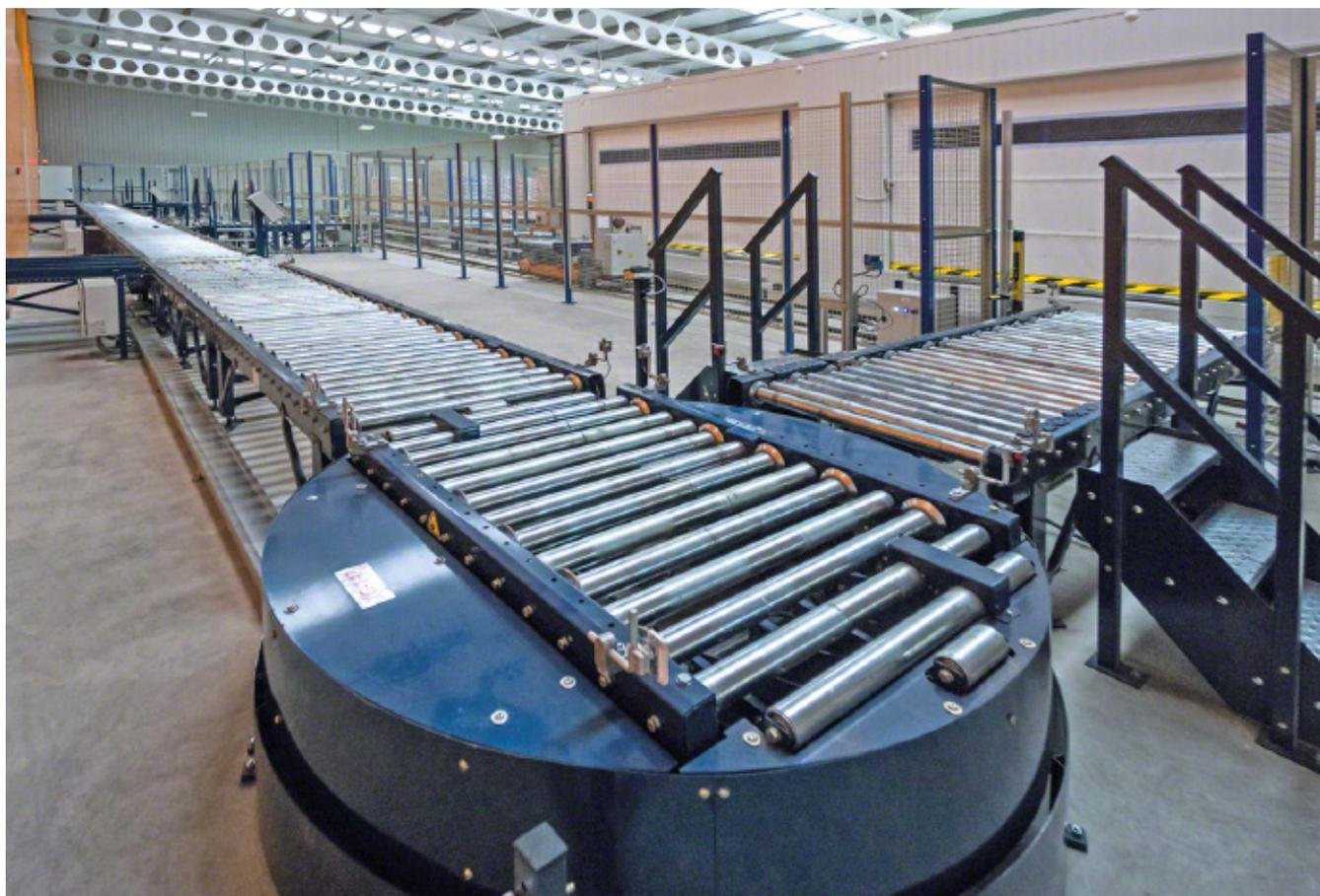
Il trasportatore girevole a rulli o a catene consente di cambiare il senso di marcia dei pallet e mantenere l'orientamento dello spostamento del carico tra linee spezzate di trasportatori dello stesso tipo (rulli o catene).
