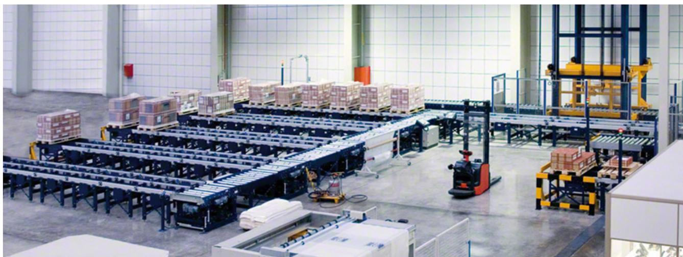
I prodotti provenienti dalle linee di produzione o preparazione **sono accumulati e classificati sui trasportatori a catene.**
