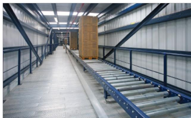
**Trasportatori a rulli ad accumulo meccanico.** Possono trasportare in modo continuo e accumulare fino a 16 pallet da 1.200 mm di lunghezza per ogni tratto di trasporto. Sono una buona opzione per realizzare circuiti rettilinei e accumulare pallet in modo continuo.
