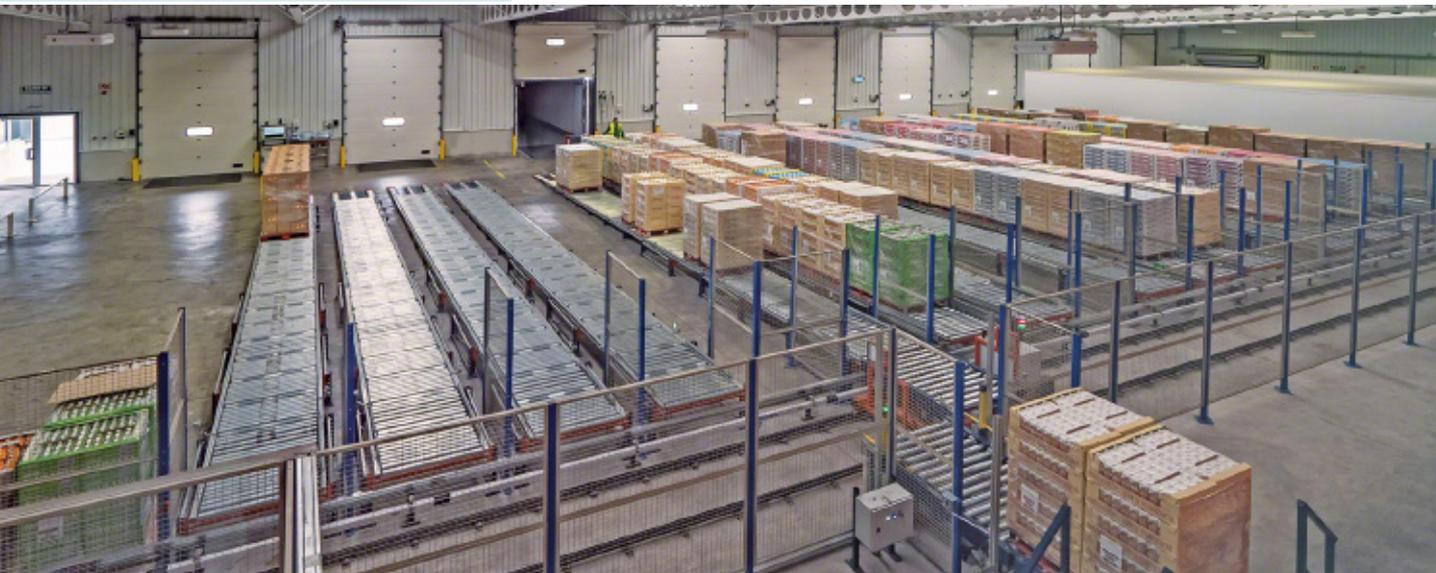
I pallet provenienti dal magazzino o dalle aree di picking **vengono classificati nei canali di precarico mediante una navetta.**
