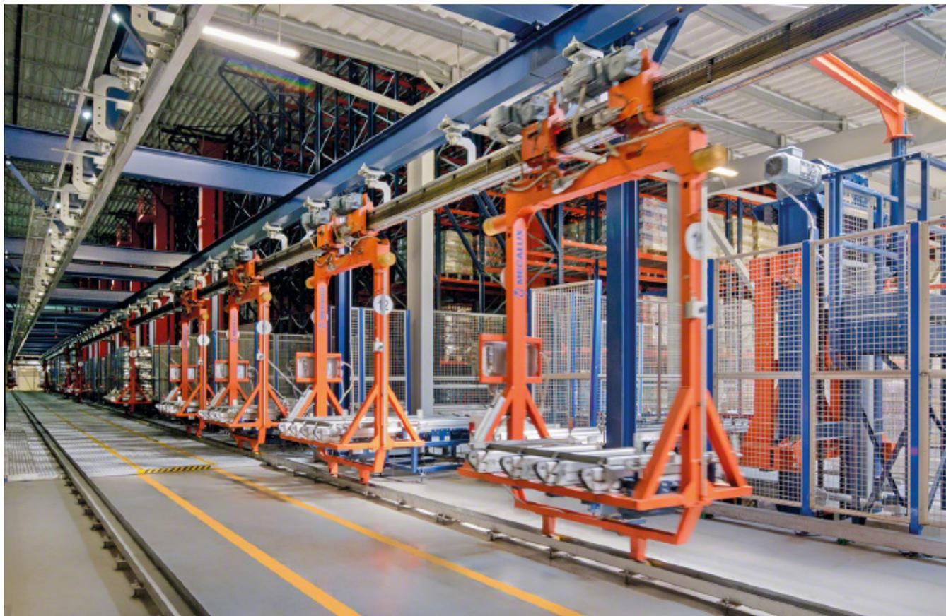
I sistemi di trasporto automotore sono costituiti da navette automatiche, o ad autopropulsione, che si spostano su binari elettrificati che formano un circuito chiuso. Un numero variabile di navette percorre il circuito trasferendo i pallet tra le varie stazioni o punti di fermata, seguendo gli ordini ricevuti dai programmi di gestione e controllo.
