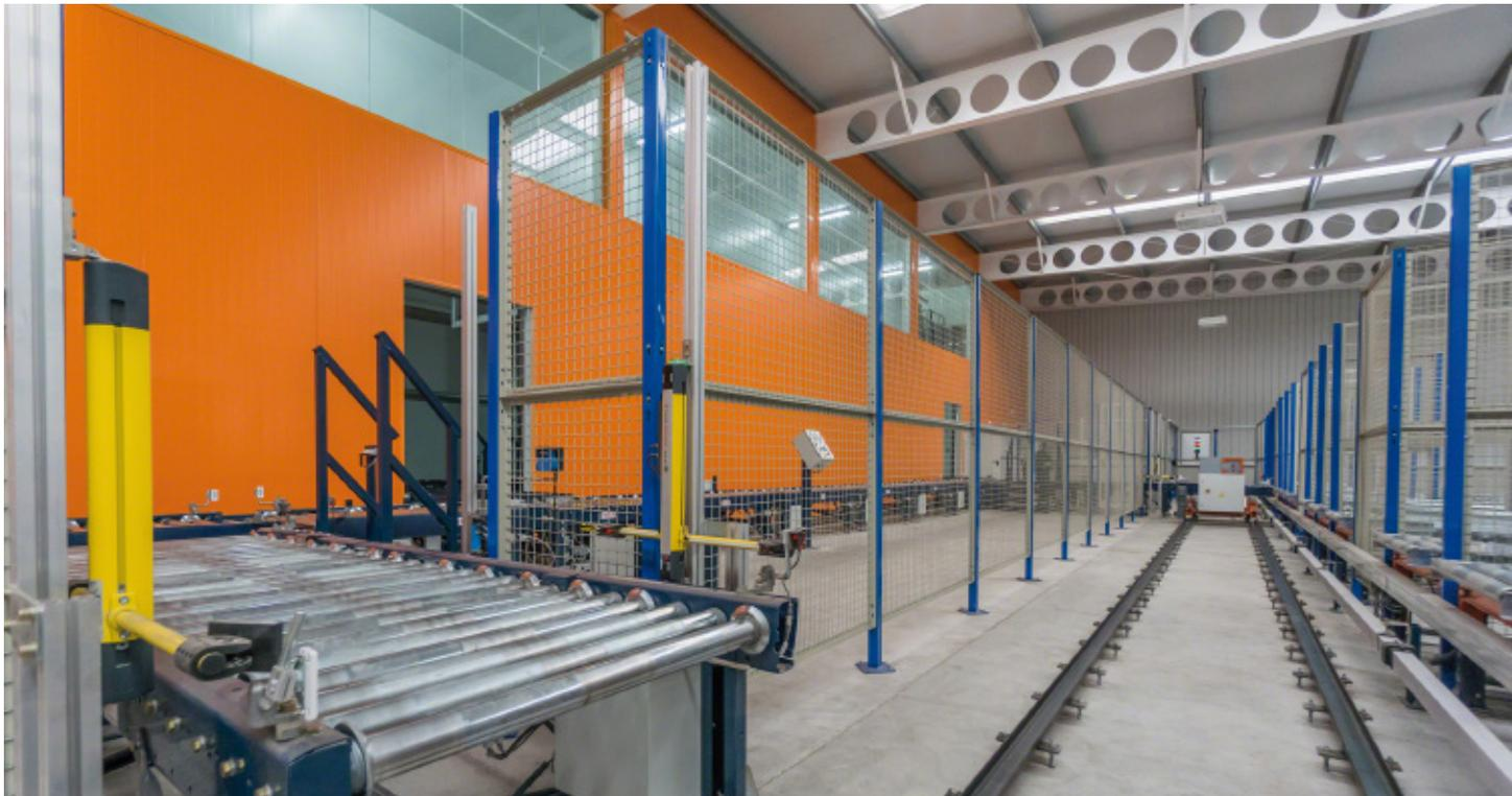
I circuiti sono integrati con recinzioni di sicurezza, come i ripiani in rete e le porte con controllo degli accessi, che offrono la massima protezione per gli operatori dell'impianto.
