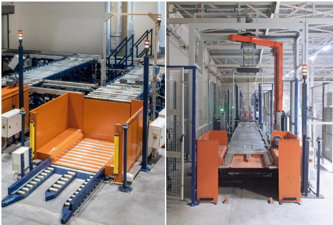
Questo elemento alza l'unità di carico dalla quota 0 all'altezza del circuito mediante un sistema di sollevamento idraulico. Questi trasportatori sono disponibili in due versioni:
