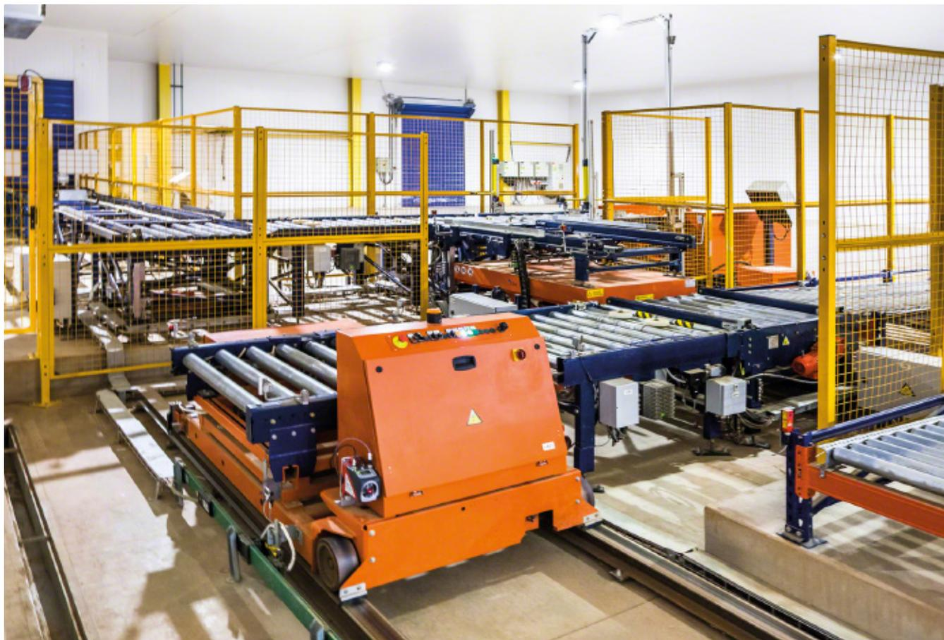
Sistema di trasporto non continuo di unità di carico. È una navetta che si sposta su guide lungo una traiettoria rettilinea, rendendo possibile l'unione tra vari punti intermedi. La sua lunghezza si adatta alla distanza da coprire dato che si monta su guide indipendenti a terra o incassate.
