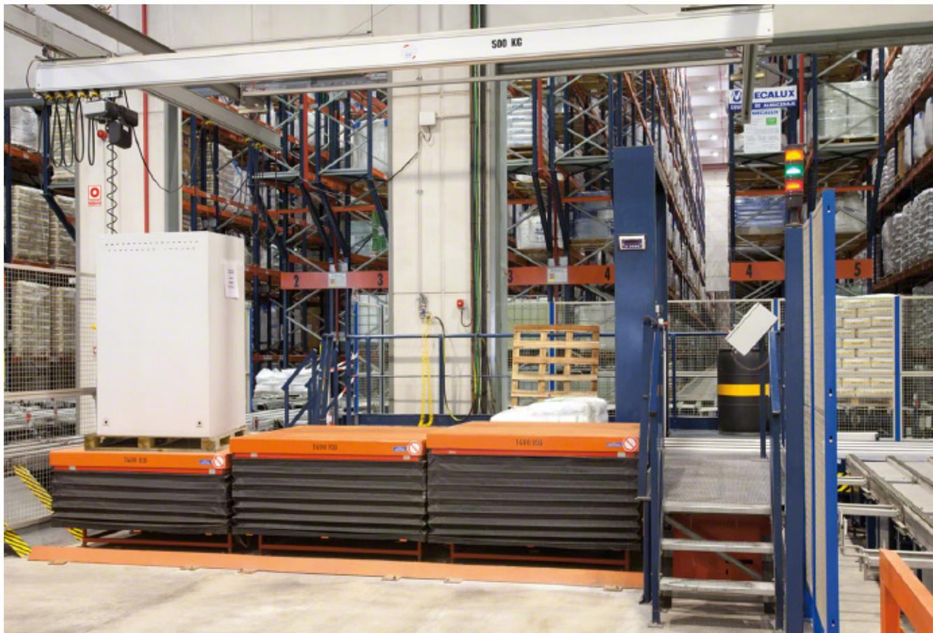
Per rispettare la posizione ergonomica dell'operatore sulle postazioni di picking, è consigliabile affidarsi a questo tipo di banchi. La loro funzione è quella di adattare l'altezza della merce alla posizione corretta di movimentazione nelle operazioni di preparazione ordini.
