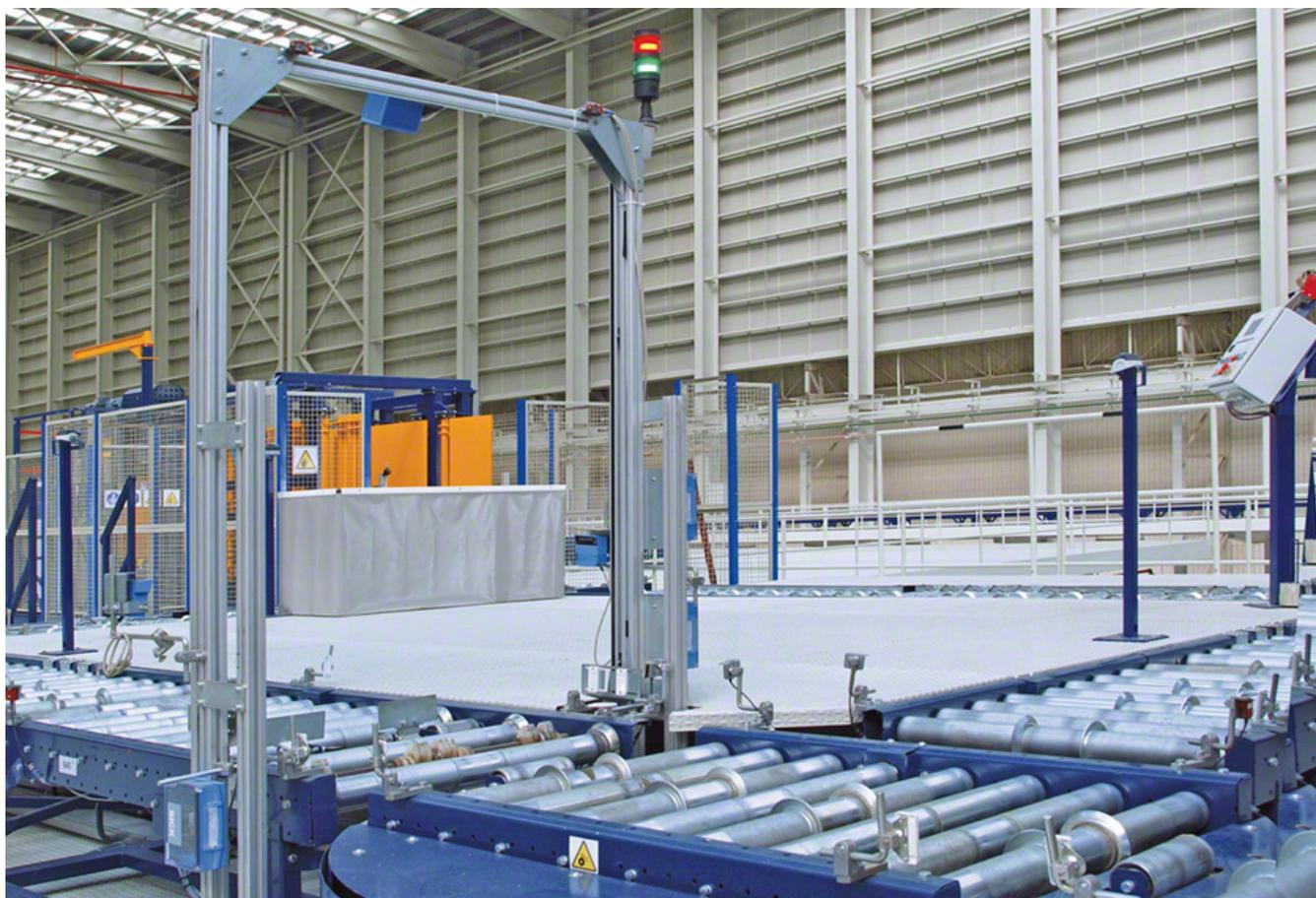
La postazione di ispezione e controllo in entrata (PIE) viene installato nei casi in cui sia necessario verificare che le dimensioni, il peso e lo stato dei pallet soddisfino le specifiche dell'impianto, soprattutto quando il sistema di trasporto viene utilizzato per inserire i pallet in un magazzino automatico.
