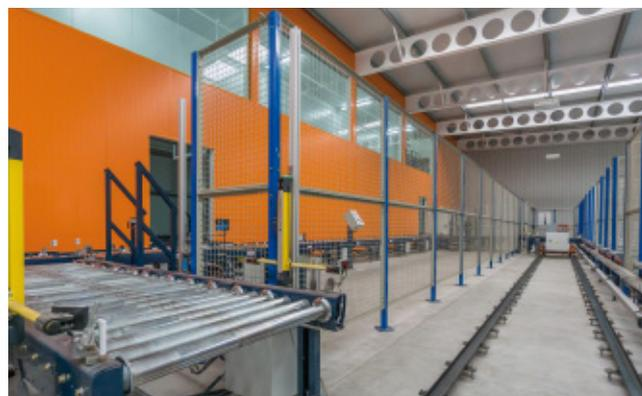
**Navette singole.** Possono fungere da trasportatore principale di un circuito con varie origini e una destinazione unica, unendo tra loro i vari punti. Rappresenta una scelta ideale quando il flusso delle movimentazioni non è elevato ed è necessario colmare grandi distanze a costo minimo.
