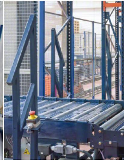
Con questi modelli di trasportatori base si possono costruire circuiti con tracciati irregolari, combinando tratti con moduli a rulli e altri con moduli a catene, oppure con tratti che hanno moduli dello stesso tipo.
