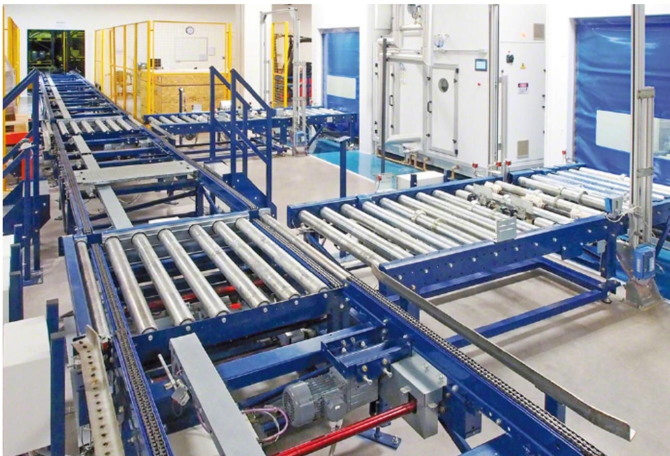
Trasportatore combinato a rulli e a catene che consente il cambiamento di direzione e orientamento dei pallet. I rulli sono fissati su una base di appoggio e le catene si posizionano su un telaio di sollevamento. Al fine di facilitarne il corretto funzionamento, l'altezza del trasportatore a catene è sempre 50 mm superiore rispetto a quella del trasportatore a rulli.
