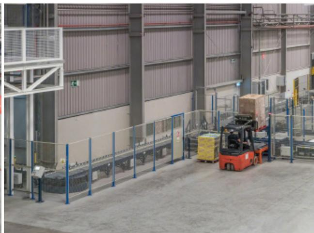
In questo caso, i **trasportatori collegano varie zone di produzione** e queste, a loro volta, con il magazzino. Includono collegamenti diretti con l'uscita delle formatrici di pallet, l'entrata attraverso carrelli elevatori e l'area di verifica e controllo della qualità.
