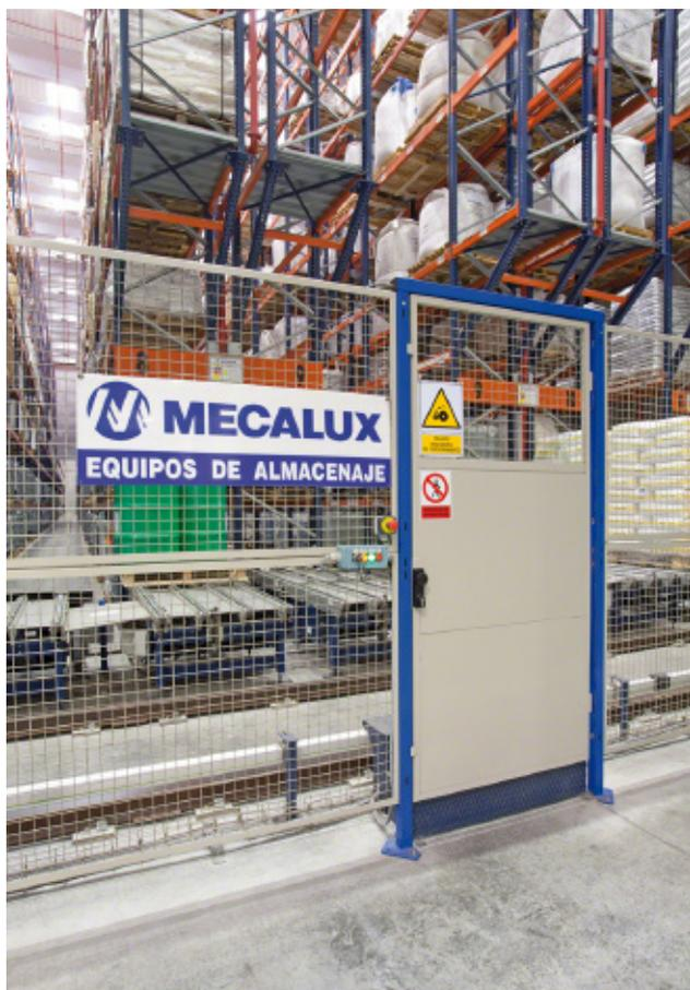
Si tratta di reti verticali e di porte con dispositivi che permettono di controllare gli accessi. Hanno la funzione principale di delimitare le aree di rischio del circuito di trasporto allo scopo di evitare incidenti.
