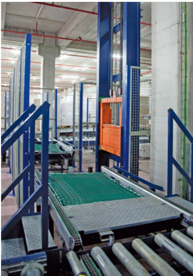
Sui trasportatori che si trovano davanti a corsie con macchine in movimento, trattandosi di vani aperti, è possibile installare reti orizzontali per impedire l'accesso.
