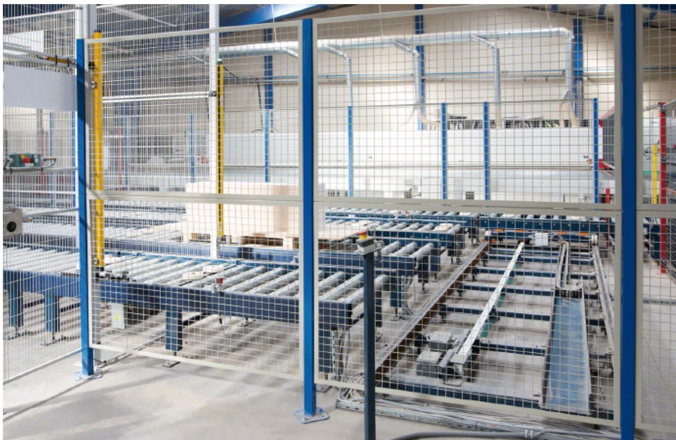
Installata su guide, effettua spostamenti longitudinali brevi, unendo vari punti di carico e scarico. Nella parte superiore è provvista di un trasportatore a rulli o a catene con capacità per un pallet.
