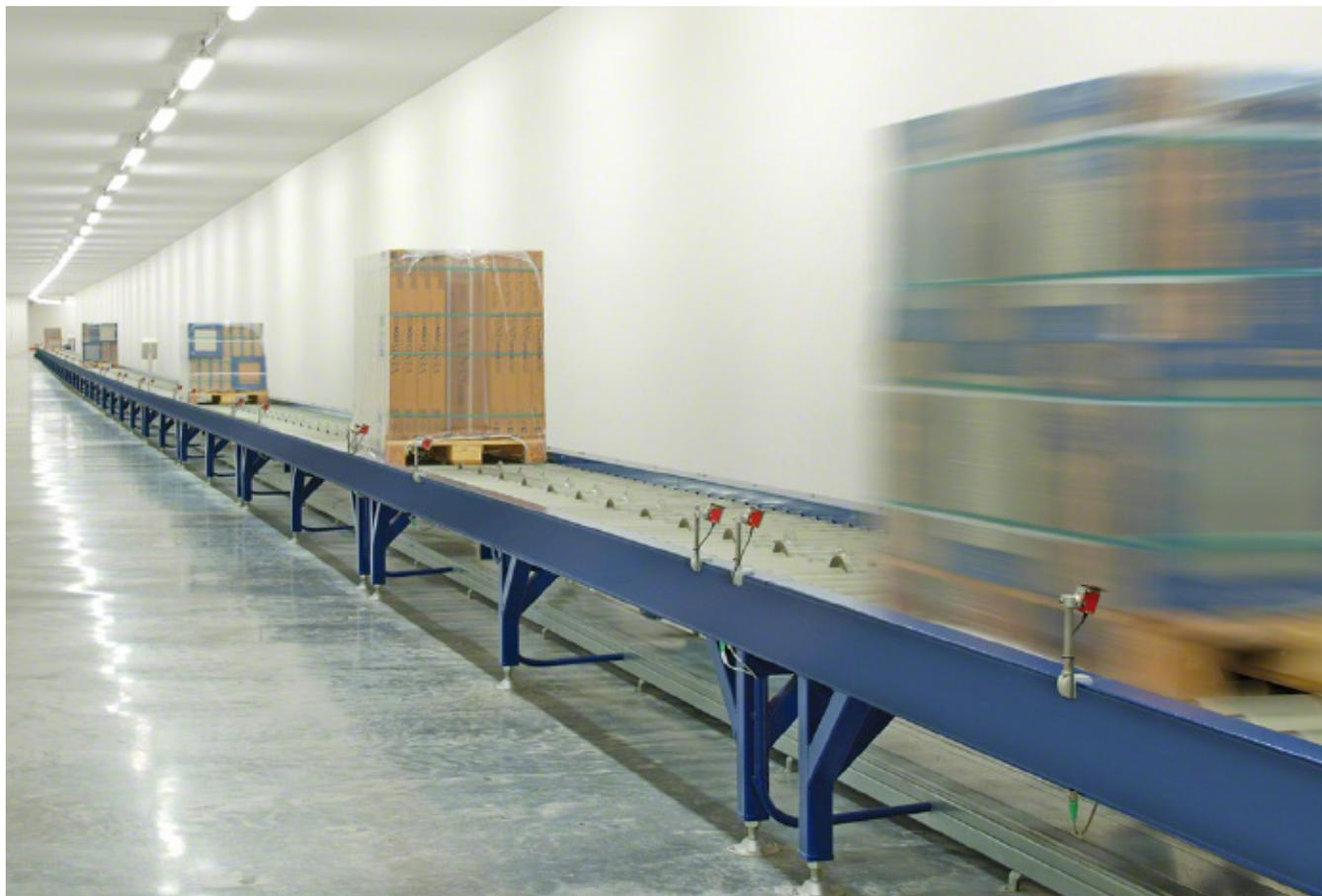
Sistema a rulli innestati che facilita l'accumulo di vari pallet riducendo i costi di materiali e manutenzione. Fornisce una movimentazione dei carichi unitaria ed è in grado di trasportare da quattro a sedici pallet su una stessa linea azionata da un unico motore o su quattro linee parallele che trasportano fino a quattro unità di carico ciascuna.
