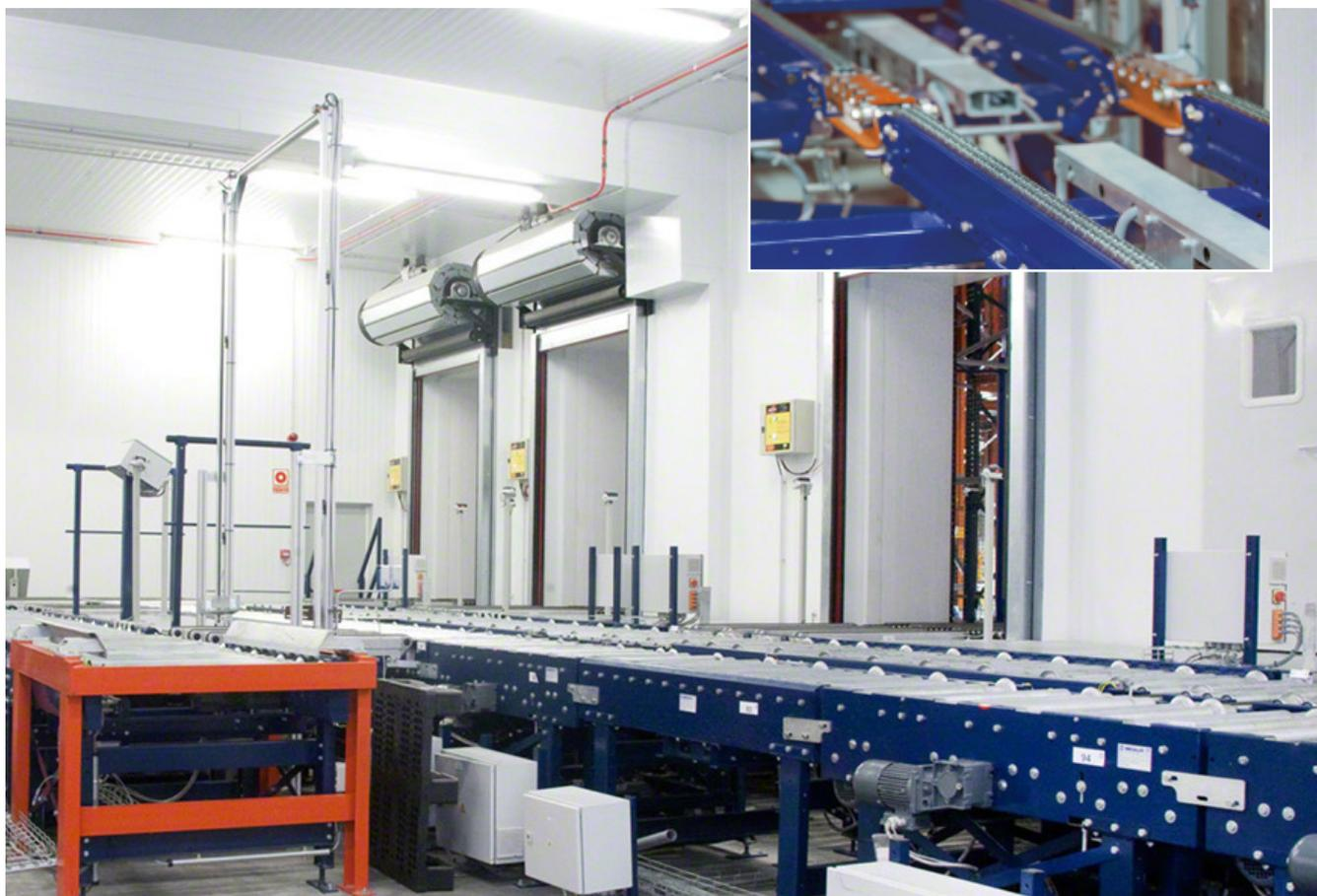
Quando è necessario installare una porta in mezzo a un circuito di trasportatori a catena, indipendentemente dal fatto che sia tagliafuoco o di accesso alle aree di refrigerazione, si crea un'interruzione sulla linea di trasporto che obbliga a lasciare uno spazio di 200 o 300 mm fra i trasportatori.
