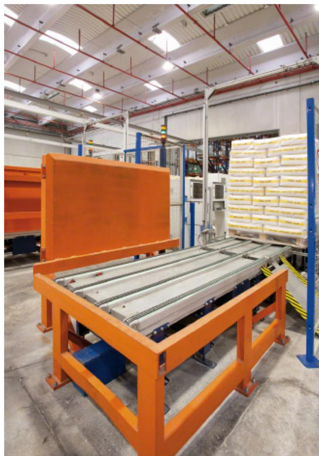
Queste difese metalliche vengono posizionate sui trasportatori in ingresso e uscita per evitare che subiscano danni depositando o prelevando i pallet con un carrello elevatore. La difesa in entrata è dotata di centratori di pallet che facilitano la corretta ubicazione dell'unità di carico sul trasportatore.
