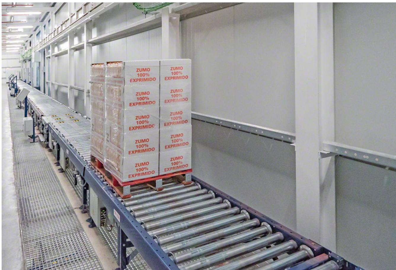
Questo elemento di trasporto è in grado di effettuare spostamenti longitudinali e coprire lunghe distanze a basso costo, trasportando carichi tra vari punti di un impianto. I pallet vengono trasferiti con le slitte allineate nella direzione dello spostamento e appoggiati perpendicolarmente sui rulli.
