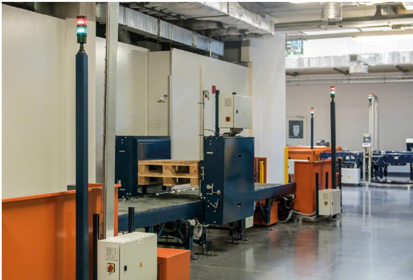
Complemento per sistemi di trasporto automatico che agevola lo stoccaggio di pallet vuoti ovvero la loro integrazione nel circuito.
