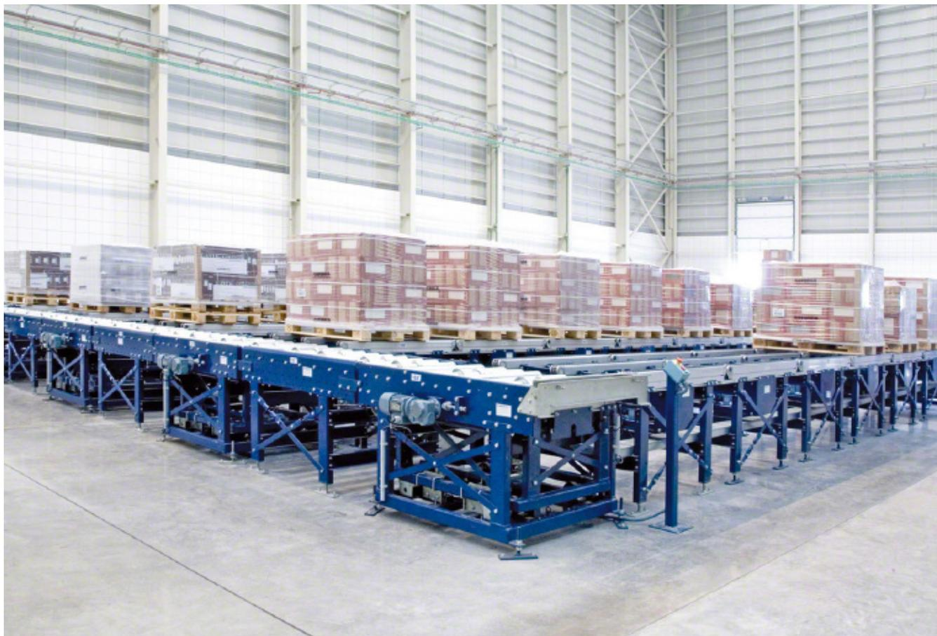
Si tratta di trasportatori rettilinei (a rulli o a catene) in grado di effettuare spostamenti longitudinali e coprire lunghe distanze a un costo contenuto trasportando carichi tra vari punti dell'impianto. Il trasporto è sequenziale in quanto è pensato per trasferire fino a 4 pallet alla volta per modulo. La gestione della posizione di ogni pallet viene controllata mediante fotocellule che consentono l'accumulo dei pallet mantenendo una piccola distanza tra essi.
