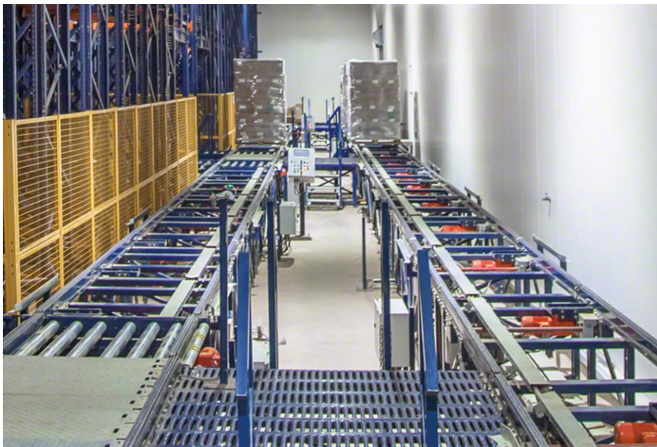
Elemento per il trasporto dei pallet con le slitte orientate in direzione perpendicolare al suo spostamento (europallet movimentato dal lato di 1.200 mm). Una larghezza unica consente di trasportare tutti i tipi di pallet. Per i pallet Dusseldorf è necessario un modulo specifico con quattro diramazioni a catene.
