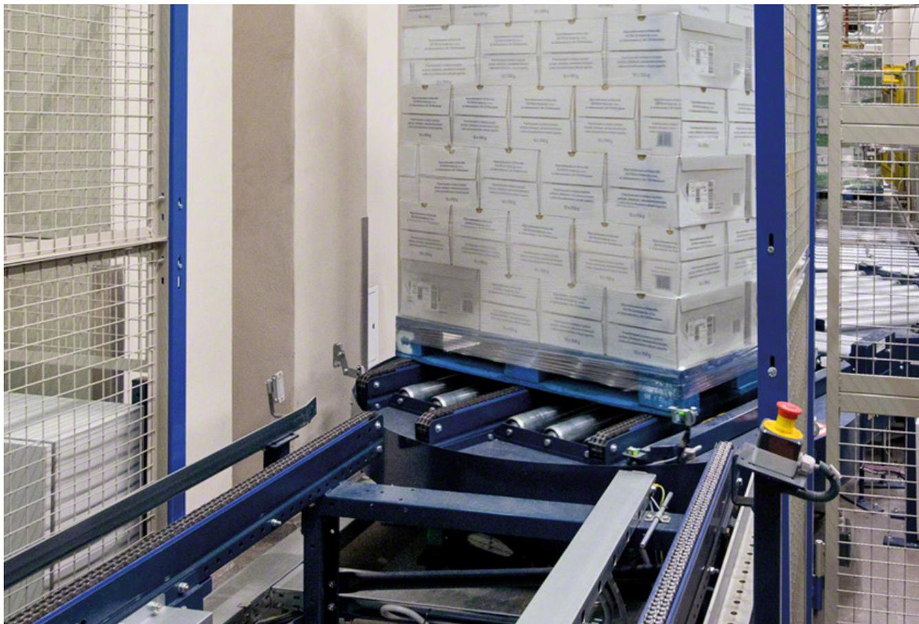
Il trasportatore girevole a rulli e a catene consente di modificare il senso di marcia del pallet oltre all'orientamento del trasporto con la possibilità di cambiare da catene a rulli, o al contrario, in rettilineo.
