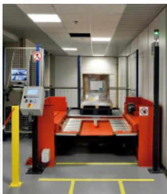
**Trasportatori a rulli con imboccatura per carico con transpallet.** Sono indispensabili per operare a livello del pavimento quando si muove la merce con i transpallet. Si presentano con e senza sollevamento.
