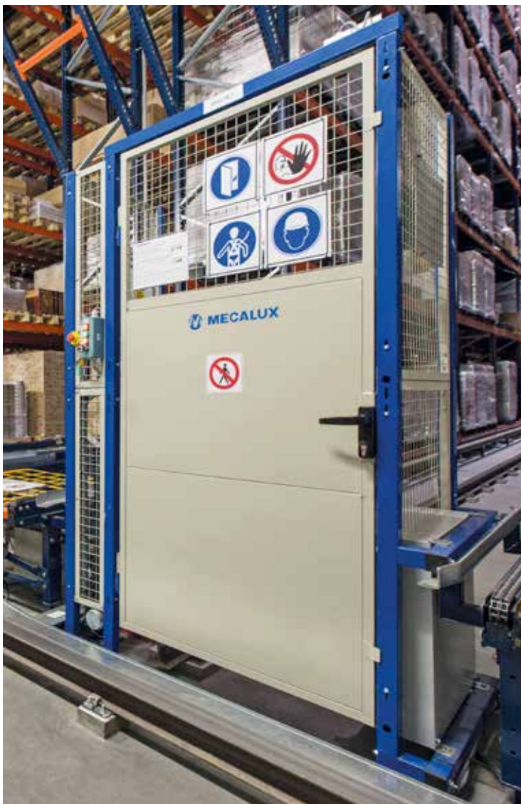
Chiusura delle zone di controllo e manutenzione
