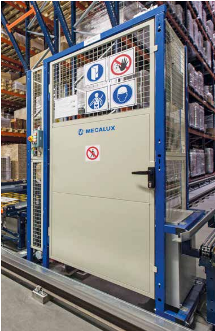
Chiusura delle zone di controllo e manutenzione
