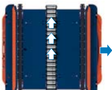
Trasmissione laterale dei carichi per europallet 1.000 x 1.200 mm.
