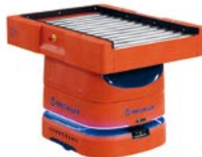
AMR 100 Box con trasportatore frontale doppio di trasmissione in serie per contenitori 600 mm di larghezza.
