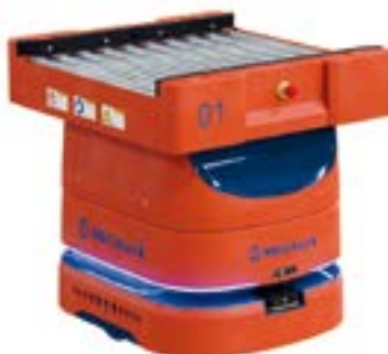
AMR 100 Box con trasportatore laterale per un contenitore da 600 mm di larghezza.
