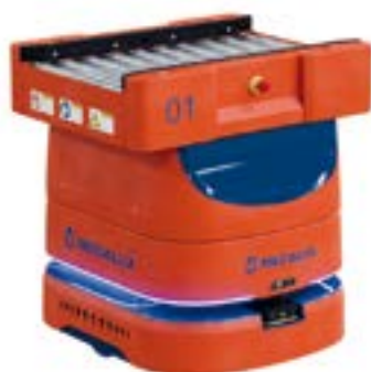
AMR 100 Box con trasportatore laterale per un contenitore da 400 mm di larghezza.
