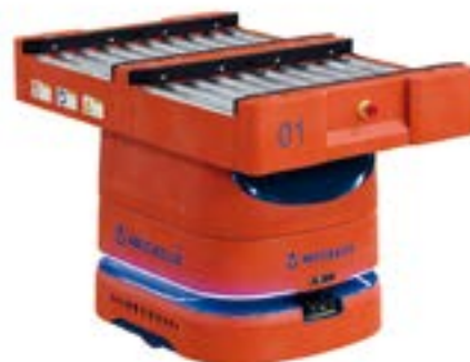
AMR 100 Box con trasportatore laterale doppio di trasmissione doppio per contenitori da 400 mm di larghezza.
