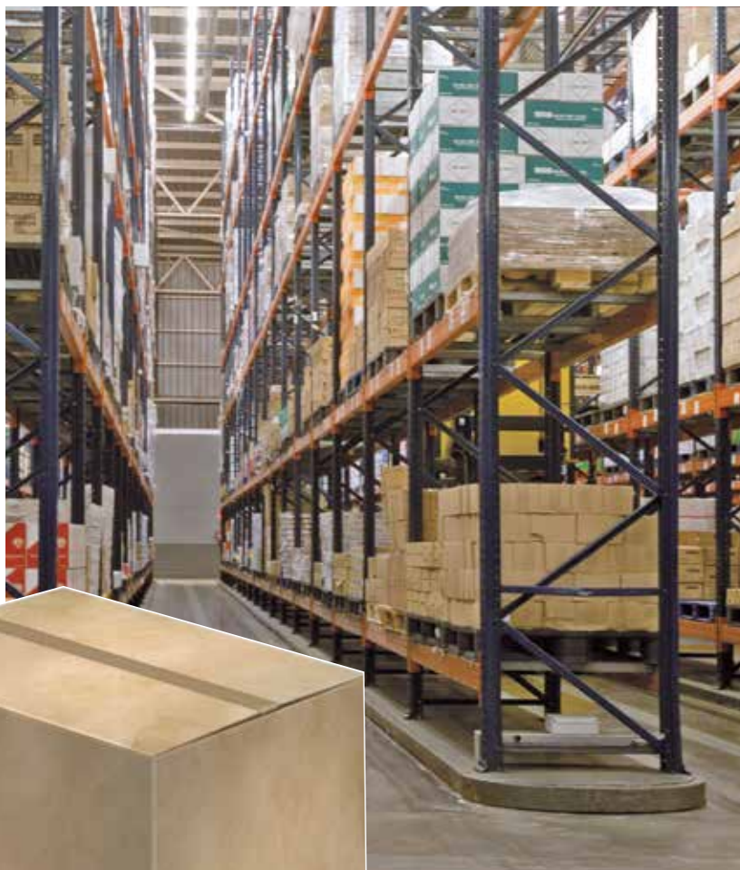
Sopra, è raffigurato il magazzino portapallet con pallet inforcato dal lato di 1.200 mm
