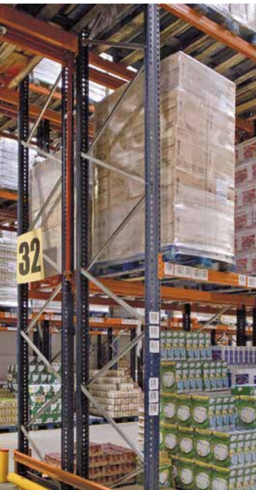
Magazzino portapallet. Pallet inforcato dal lato 800 mm
