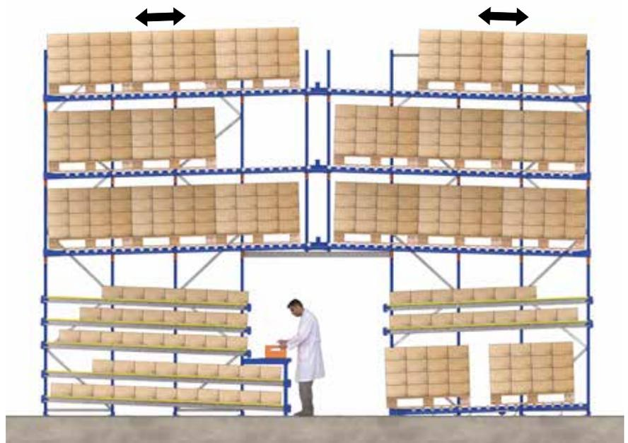
**10.** In questo caso, simile al precedente, si sfrutta come zona di riserva il volume superiore delle corsie di preparazione e, inoltre, in uno dei lati si fa picking su pallet posti su cammini a rulli inclinati.
