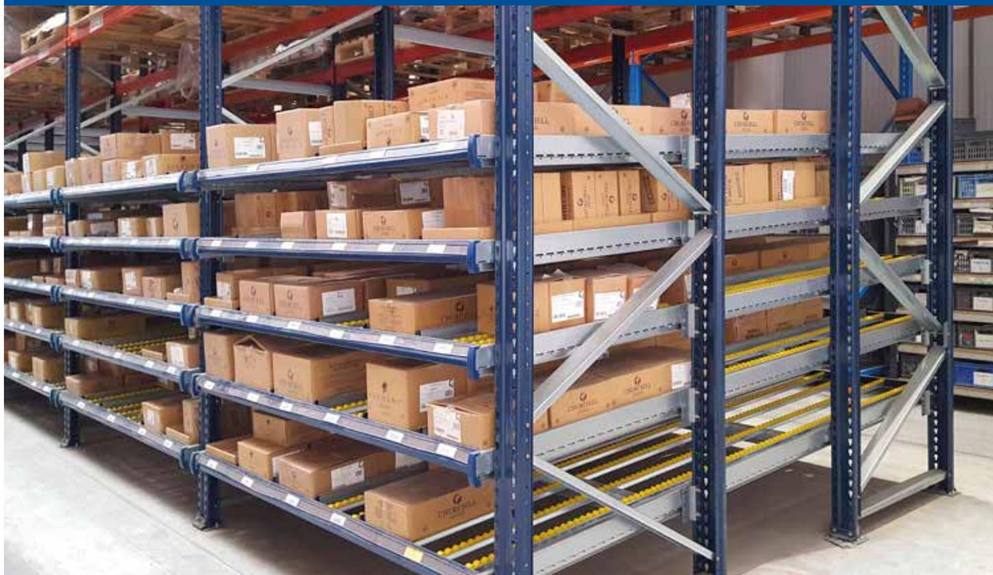
I telai o piattaforme sostengono la merce stoccata. Sono stati disegnati perché si possano unire i distinti elementi necessari e per rendere possibile qualsiasi gradazione. È molto semplice sia il montaggio che la modifica delle posizioni degli elementi regolabili.
