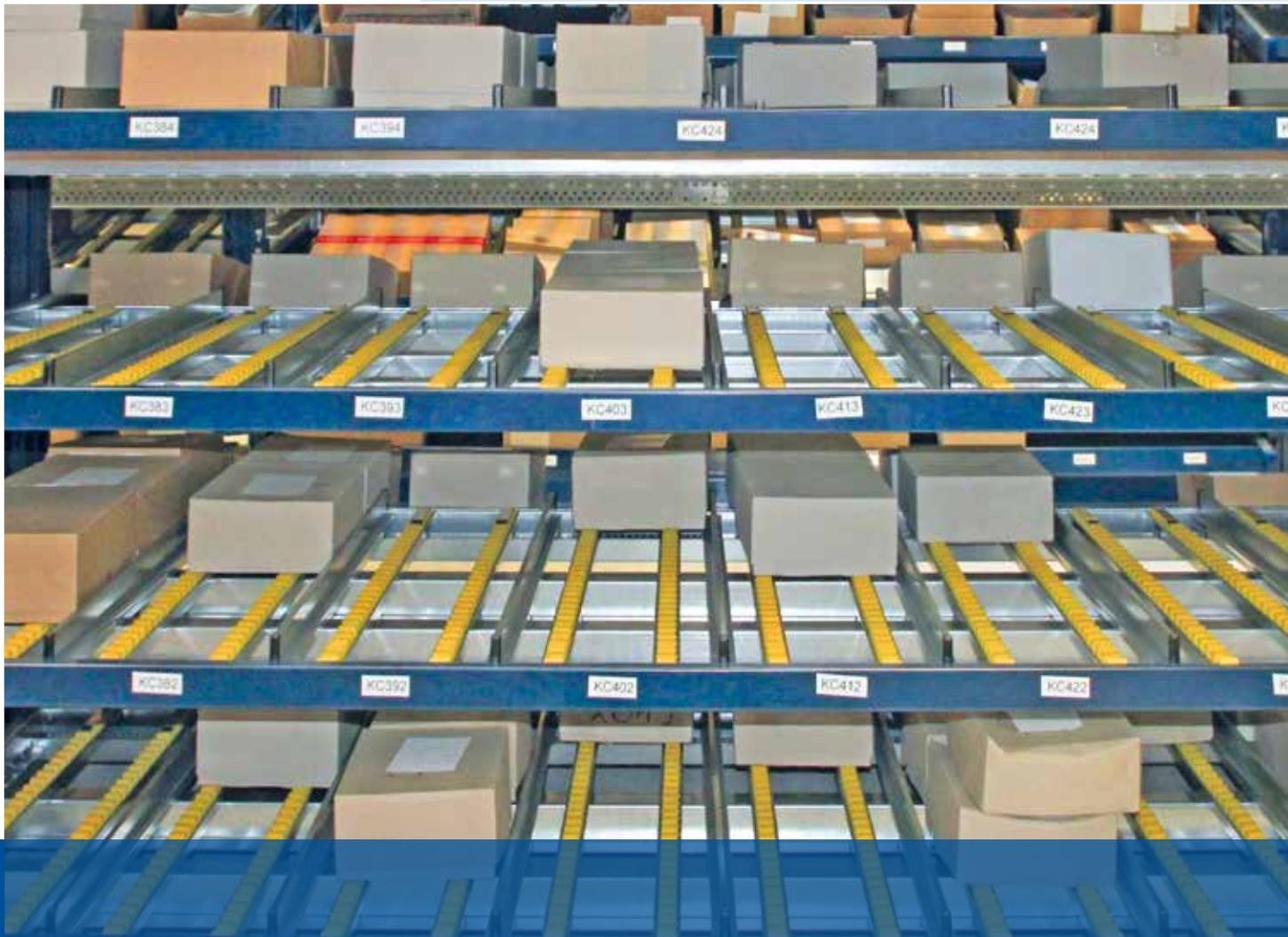
Sistema di stoccaggio a gravità per carichi leggeri che permette di ridurre il tempo di preparazione degli ordini e garantisce una perfetta rotazione della merce stoccata.
