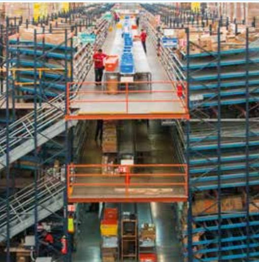
**12.** Questa soluzione rappresenta un magazzino di picking dinamico rifornito automaticamente da un trasloelevatore, che usa l'altezza del magazzino come zona di riserva.
