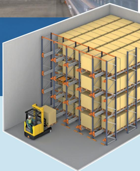
La navetta esegue le movimentazioni in modo autonomo, senza bisogno che i carrelli elevatori entrino nei tunnel di stoccaggio, seguendo gli ordini che l'operatore lancia servendosi di un tablet con connessione Wi-Fi.
