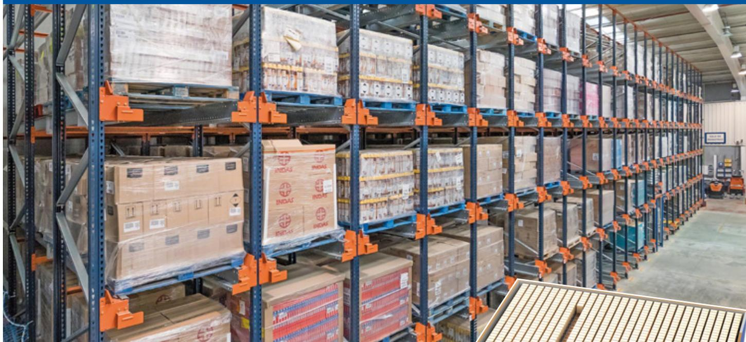
In generale, il sistema Pallet Shuttle aumenta notevolmente la produttività del magazzino quando si lavora con entrate e uscite di merci organizzate con molti pallet per referenza.
