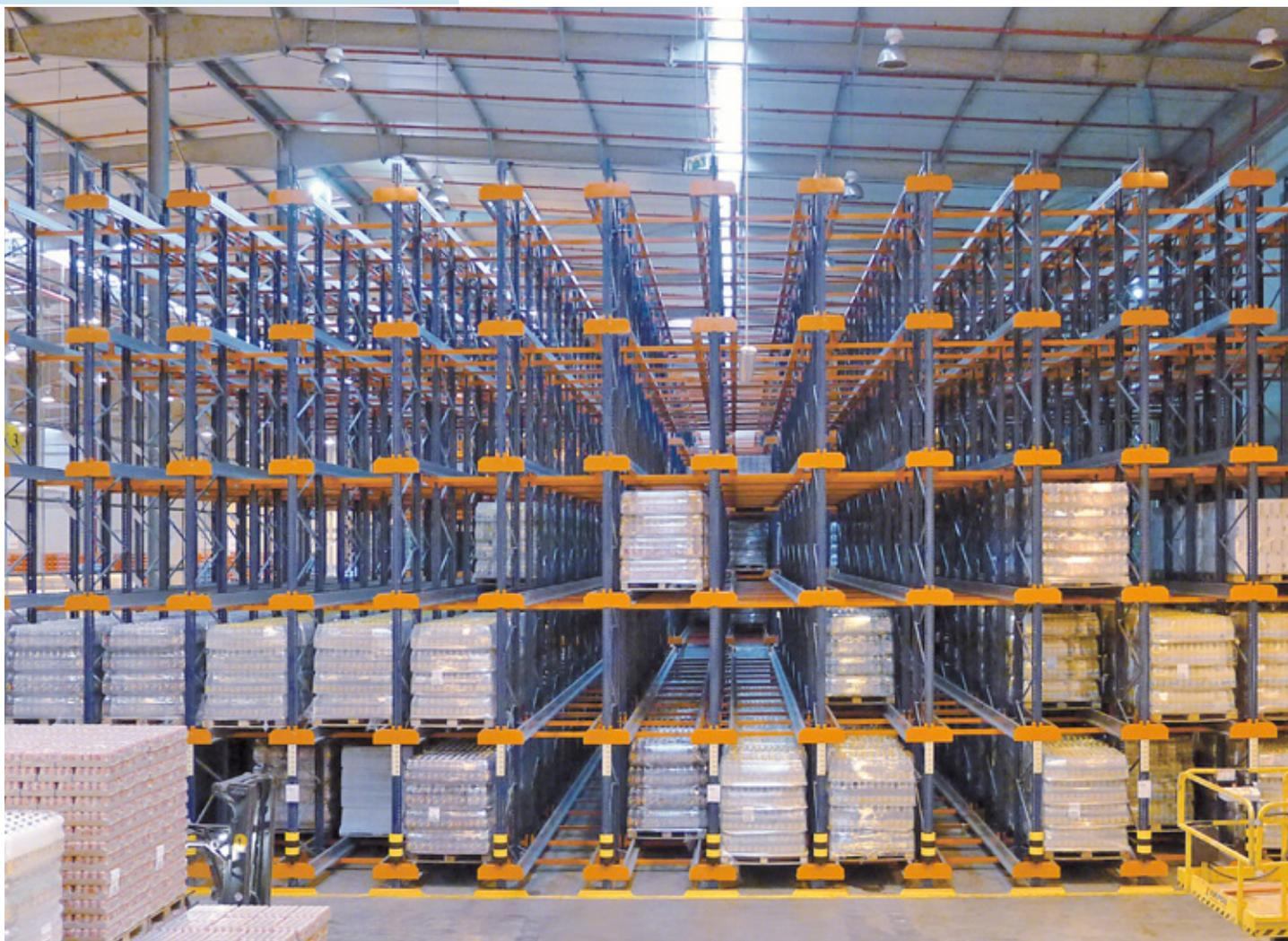
Il sistema Pallet Shuttle è anche una risorsa spesso combinata con scaffalature o livelli per eseguire le operazioni di picking. Esistono varie possibilità di rendere disponibili canali di picking sotto una struttura di scaffalature con Pallet Shuttle:
