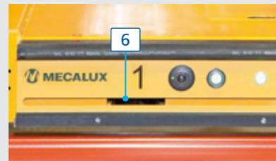
**Scanner di sicurezza (optional) (6):** si installa su ciascun lato del Pallet Shuttle per controllare in modo più sicuro l'accesso ai canali quando il Pallet Shuttle è in funzione.
