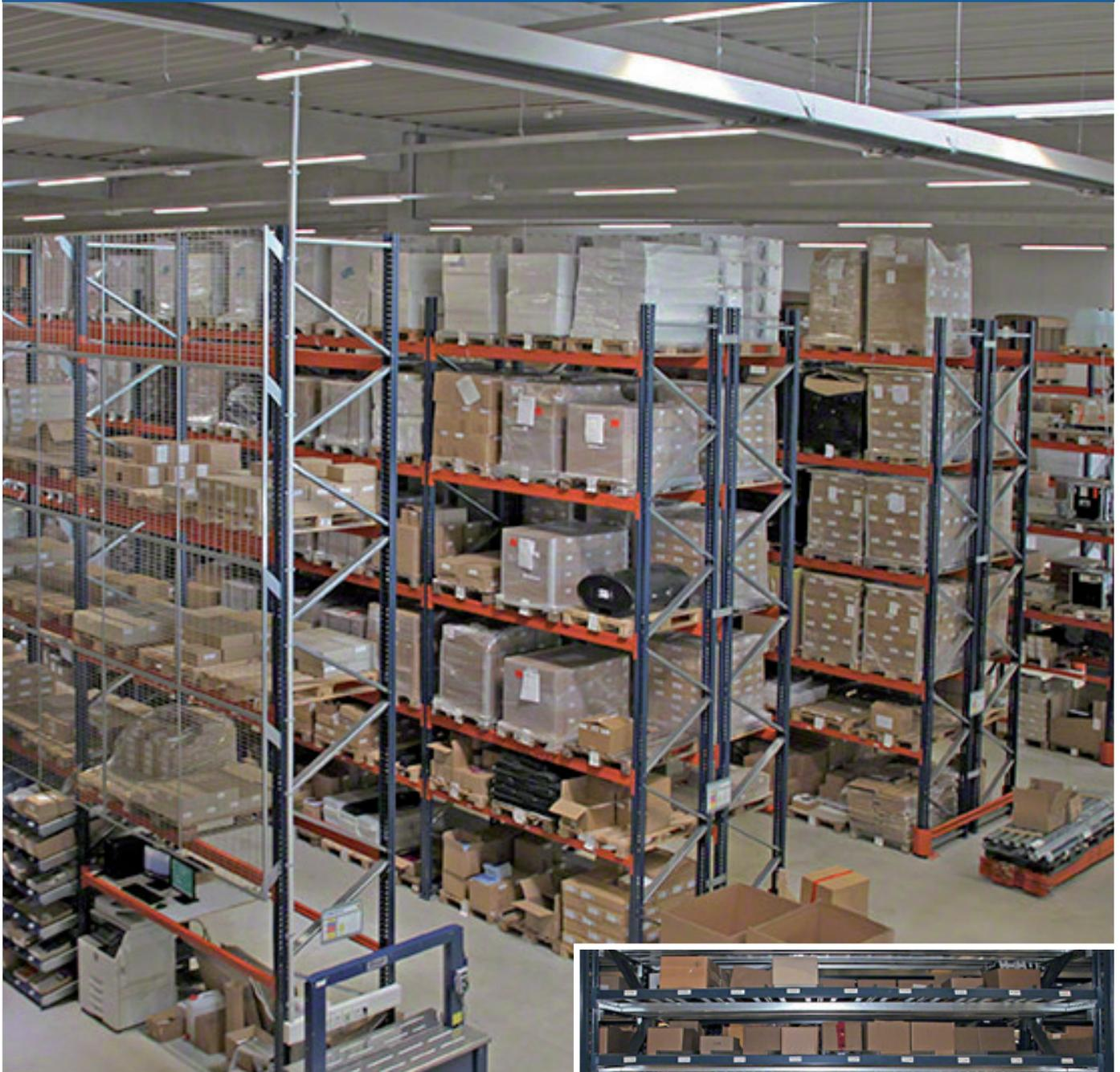
Mecalux ha attrezzato il magazzino di Company 4 Marketing Services nella città di Neufahrn bei Freising, in Germania, con il sistema di scaffalature portapallet. Le scaffalature forniscono una capacità di stoccaggio di 2.253 posti pallet massimizzando, inoltre, il rendimento della principale funzione operativa di questo centro: la preparazione degli ordini.
